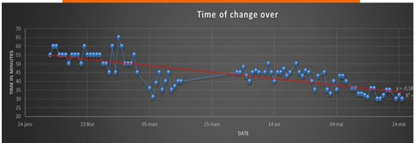
Figure XXVII: Evolution du temps de changement partiel primaire de 60min à 30min
