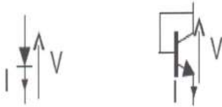
Figure I.4 : A courant constant, la tension V est linéaire en fonction de la température
