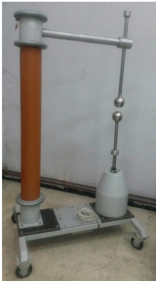
Figure IV-3 Système d'électrodes interchangeables utilisé
