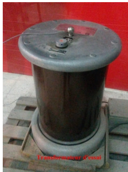
Figure III.1 Photographie du transformateur d'essai
