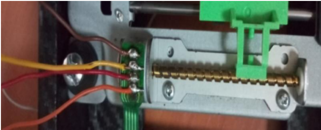
Figure III.2: Soudage des fils au niveau du moteur
