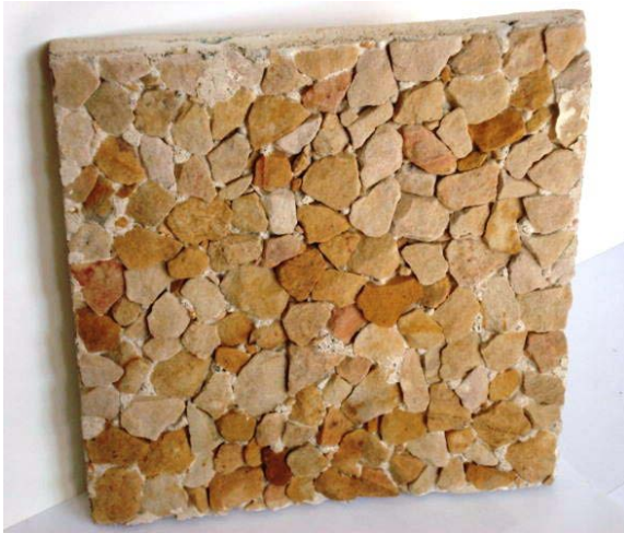
Photo 5.14 : Élément de parement à base de pierre de la région de Yakouren.
