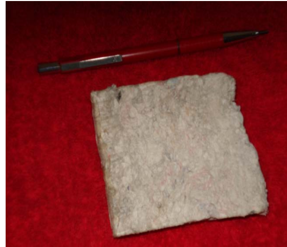
Photo 5.4. Panneau isolant à base de cellulose.
