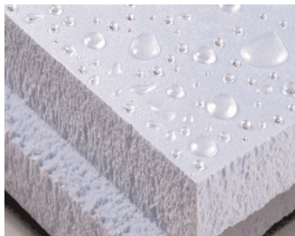
Photo 5.6. Polystyrène à structure alvéolaire poreuse.
