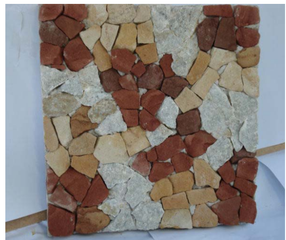
Photo 5.16 : Élément de parement à base d'un mélange de pierre (mosaïque).
