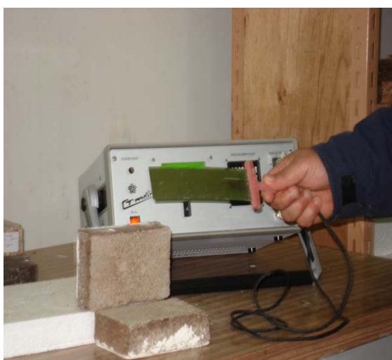
Photo 5.11. Essai au CT-mètre du CNERIB.
