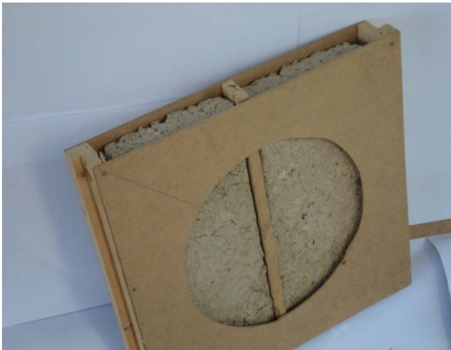
Photo 5.13. Elément isolant à base de pâte de papier (Cellulose).
