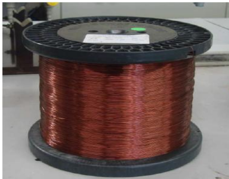
Figure IV.1 Bobine de fil de cuivre émaillé au polyamide imide et de polyester imide.
