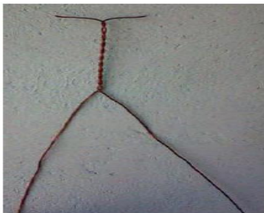
Figure IV.4. Éprouvette en forme de torsade réalisée.
