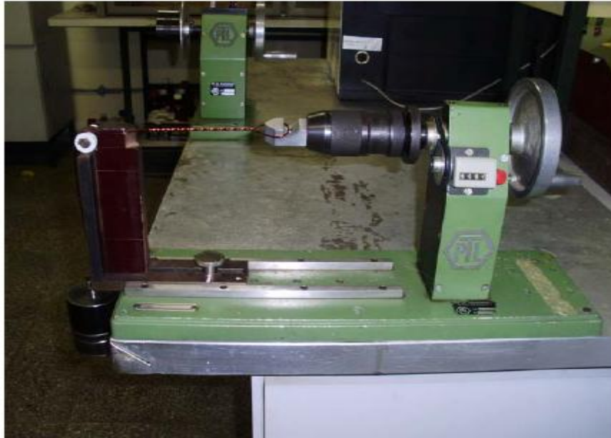
Figure IV.2. Tour à bobiner avec échantillon en cours de réalisation.
