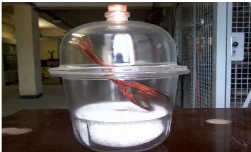
Figure IV.7. Éprouvettes en cours de conditionnement dans un dessiccateur.
