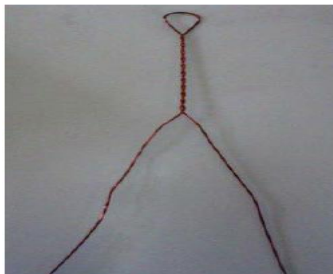
Figure IV.3. Boucle formée de la torsade confectionnée avec le tour à bobiner.
