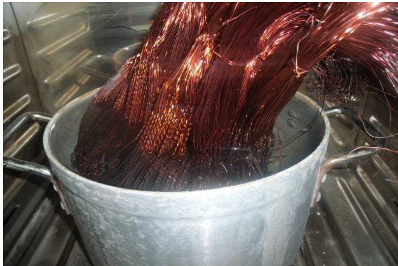
Figure IV.6. Échantillons en cours de vieillissement.
