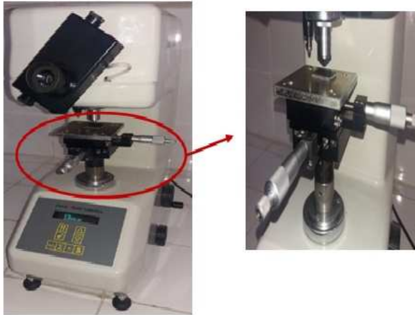
Figure IV.23 : Duromètre et empreinte Knoop.
