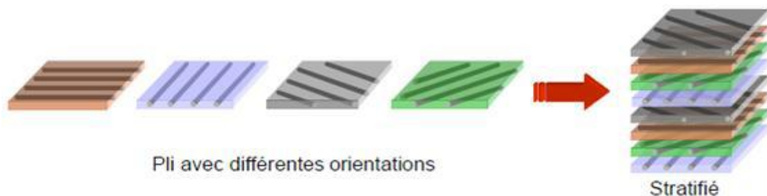
Figure III.7 : Structure d'un stratifié.
