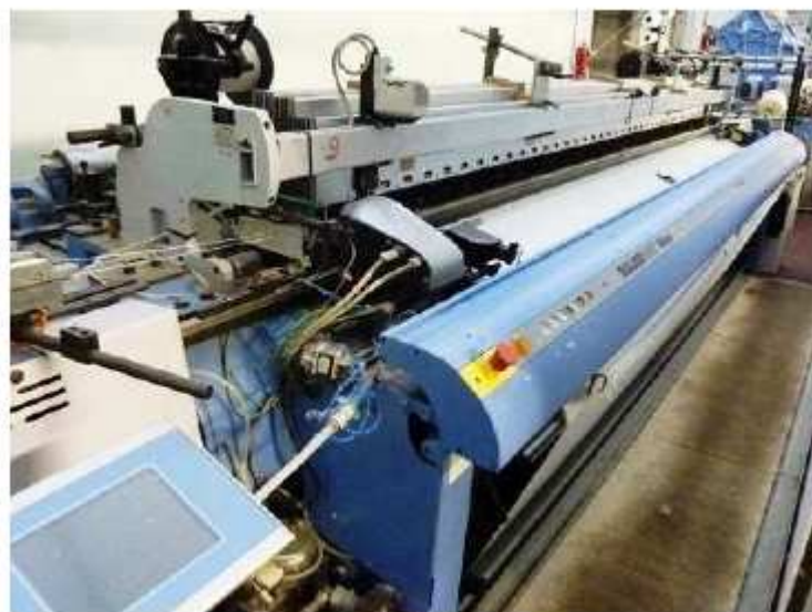
Figure I.23 : Une machine à tisser jet d'air de marque Sulzer G6500.
