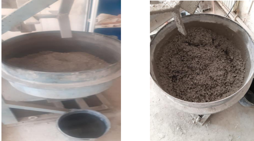
Figure III.15 : le mélange avant et après l'ajout de l'eau
