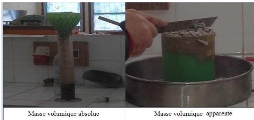
Figure III.7: Mesure de la masse volumique absolue et apparente.
