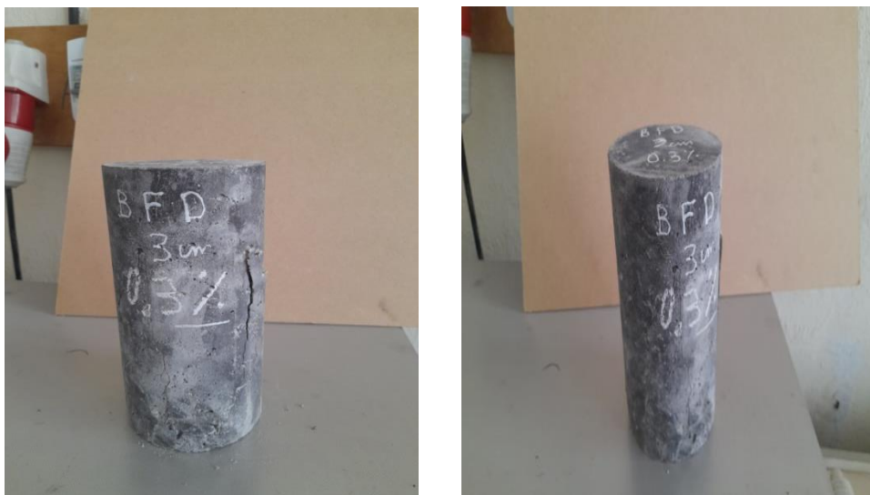
Figure IV.12: Rupture des éprouvettes cylindriques sous sollicitation de compression.
