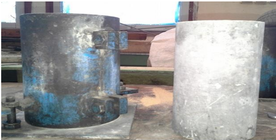
Figure III .22: Démoulage de l'éprouvette cylindrique.
