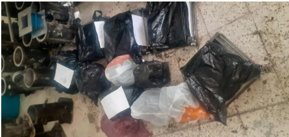
Figure III.20 : recouvrir les éprouvettes d'une toile en plastique avant démoulage.
