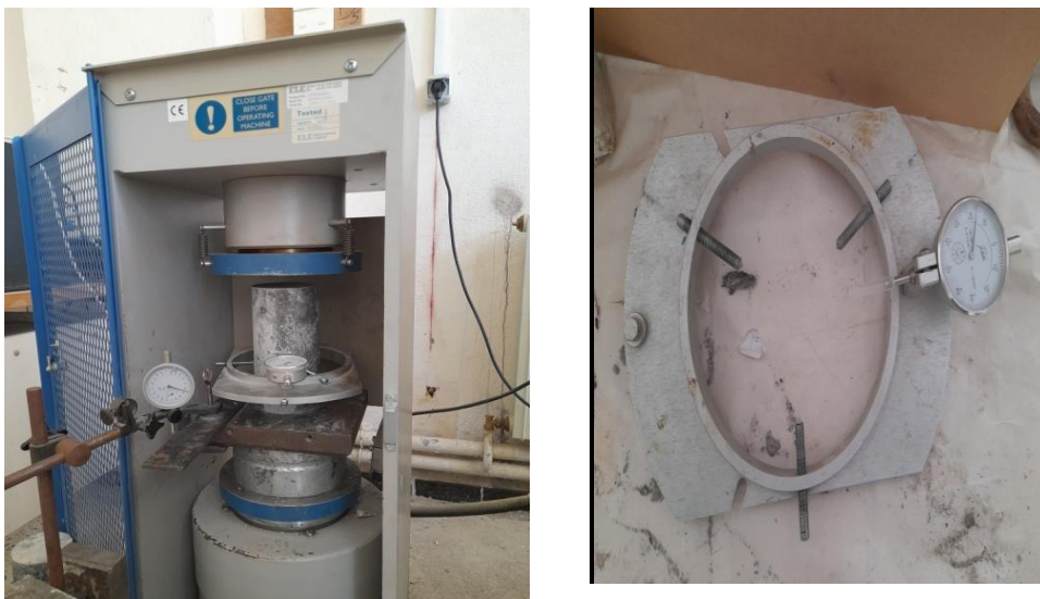
Figure IV.2 : écrasement de l'éprouvette
