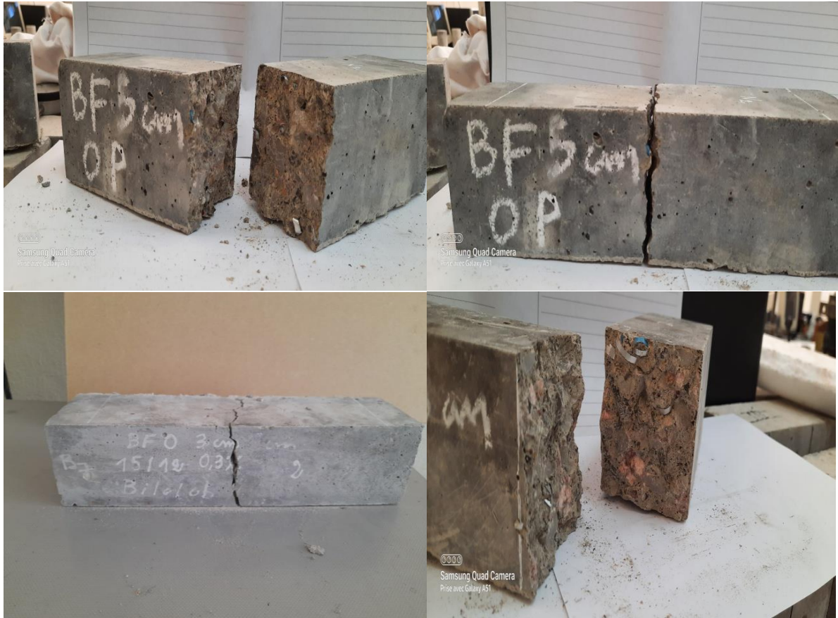
Figure IV.20 : Éprouvettes prismatiques après écrasement.
