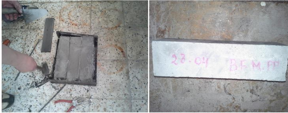
Figure III .21: Démoulage de l'éprouvette prismatique
