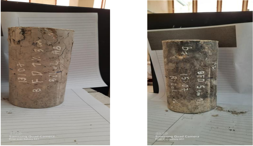
Figure IV.8: Mode de rupture des éprouvettes sous sollicitation de compression.
