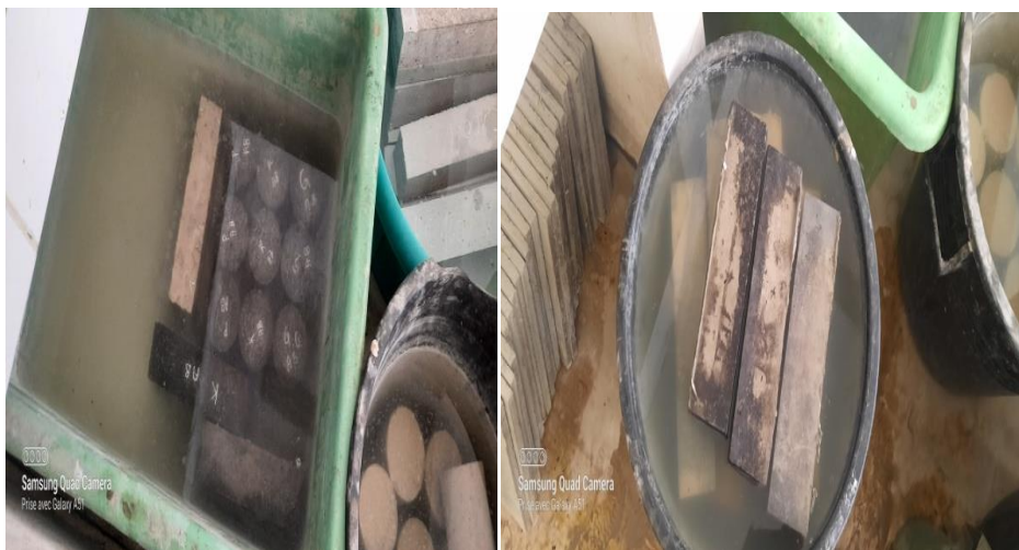
Figure III.23: préservation des éprouvettes dans de l'eau pendant 28 jours.
