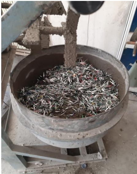
Béton de fibres droite 5 cm
