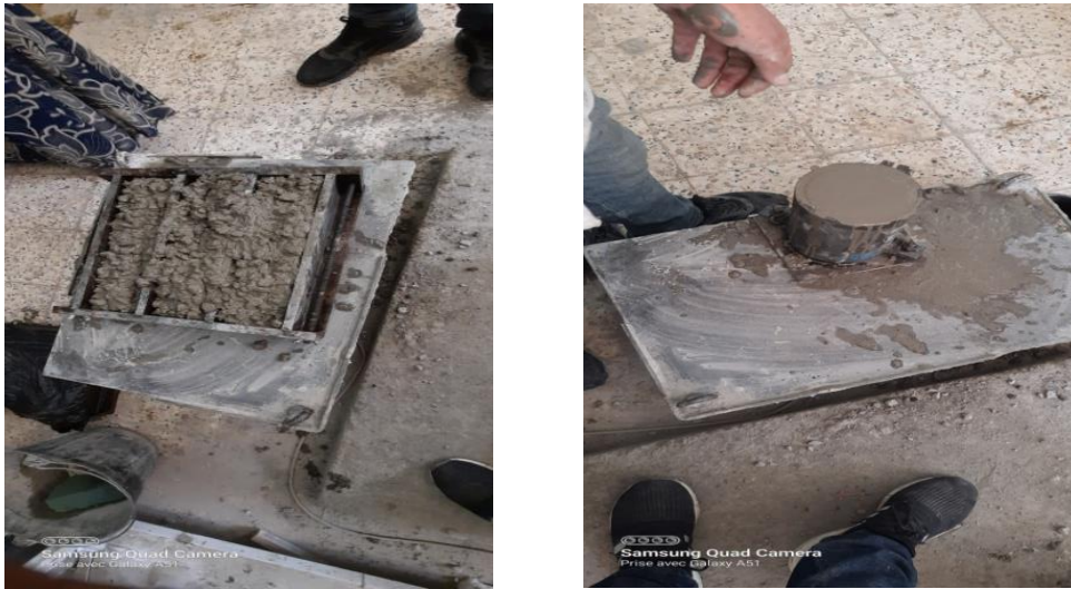
Figure III.17: vibration des éprouvettes.
