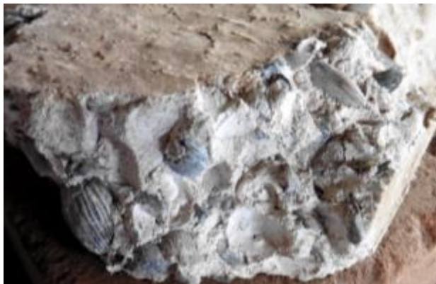
Figure 84 : échantillon de béton à base de noix de palmes source : Google. Septembre 2021
