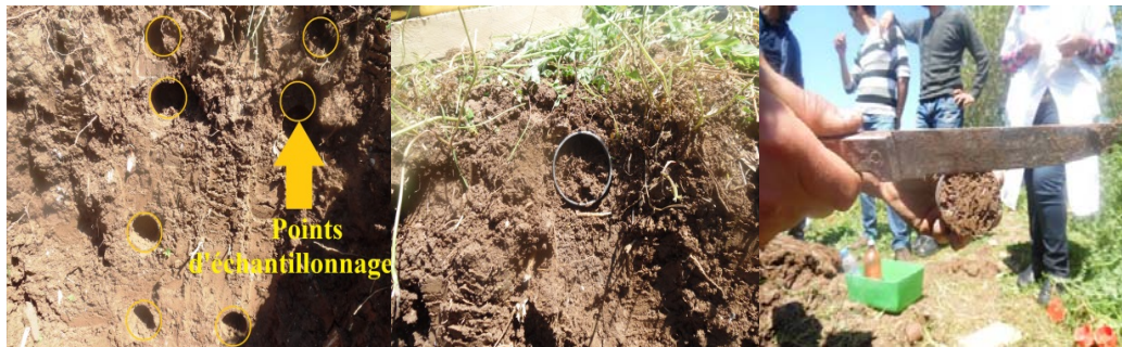
Figure 20: Mesure de la densité apparente par la méthode du cylindre
