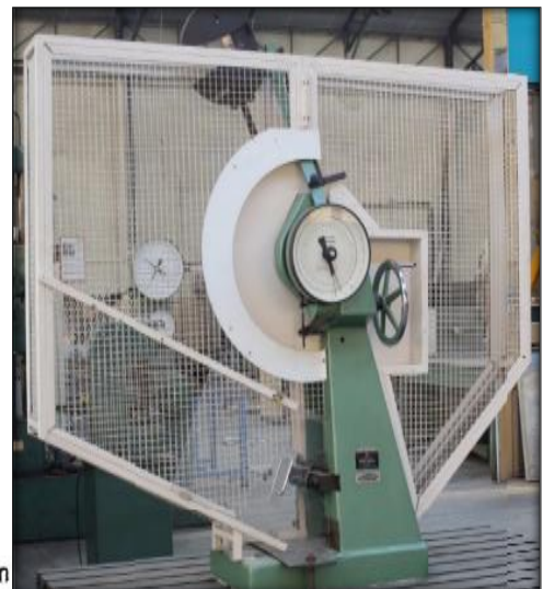
Figure III-7: Caractéristique de l'éprouvette et la machine de Résilience[16].
