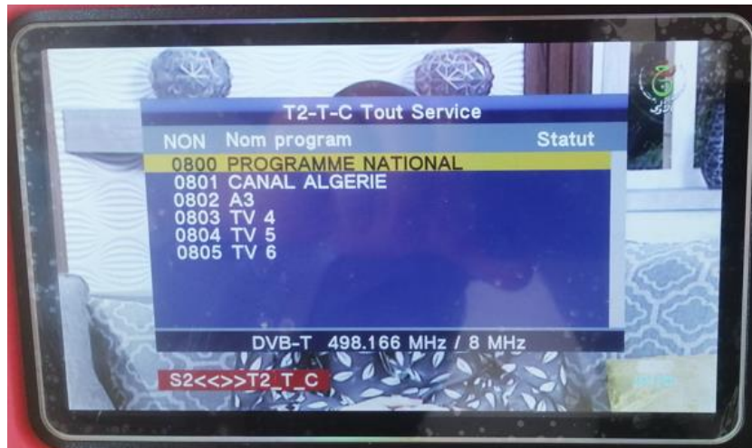
Figure 44: Multiplex (Bouquet) à diffuser par l'émetteur TNT de Bordj El Bahri.
