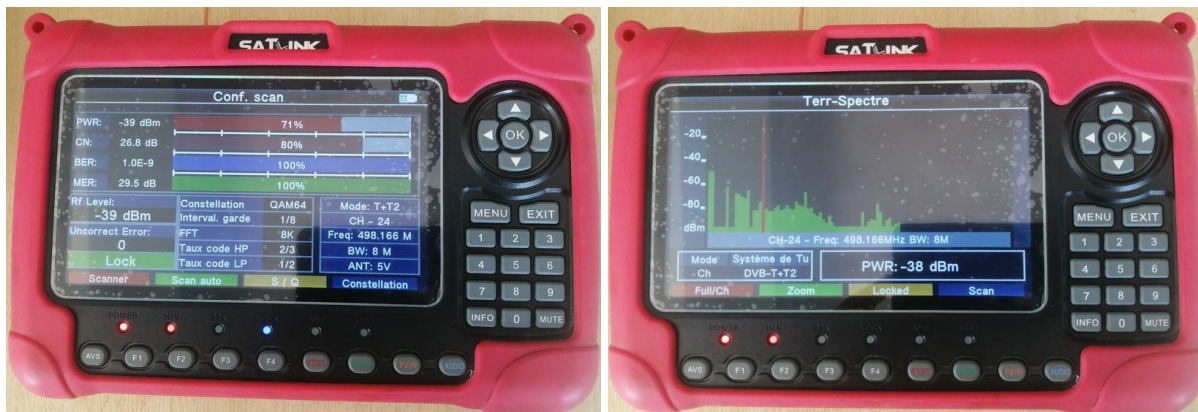
Figure 60: Réception du multiplex TNT, diffusé par l'émetteur TNT du centre TV/FM de Bordj El Bahri, sur le Canal 24 (498.166 MHz)
