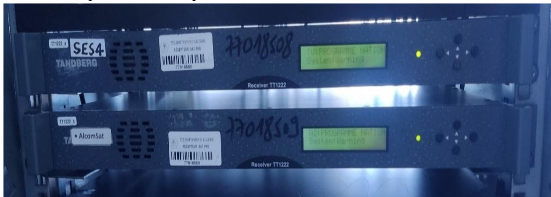
Figure 50: Les deux IRD utilisés pour démoduler les signaux provenant d'ALCOMSAT et de SES-4.
