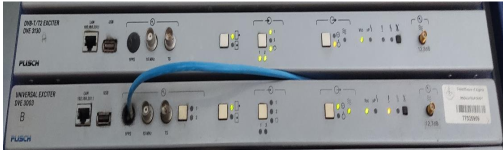
Figure 54 : Les deux excitateurs vidéo numérique DVE 3130.
