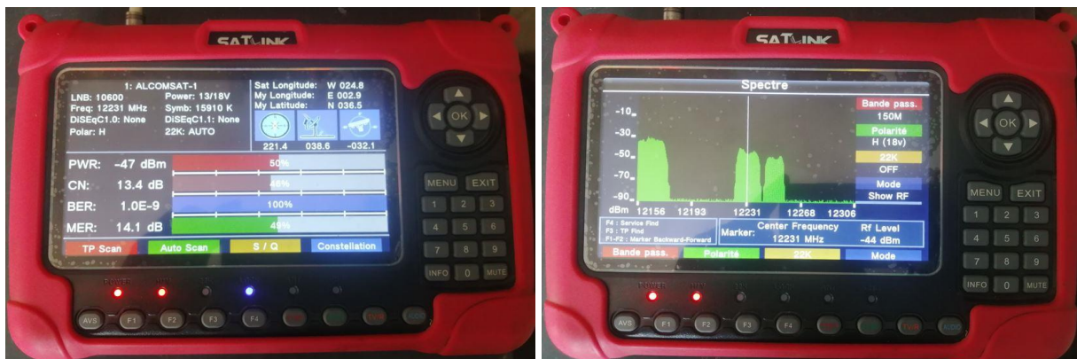
Figure 68 : Réception du bouquet de 6 chaînes SD algériennes, diffusé par le satellite Alcomsat-1 (Fréquence : 12231 MHz).
