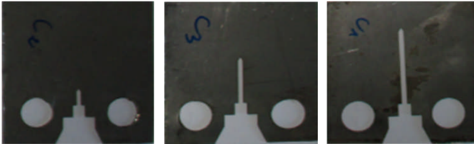
Figure III.13 Eprouvettes CT testées pour épaisseur ( e=0.8 mm)
