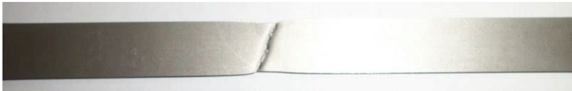
Figure III.4 La partie utile de l'éprouvette après sollicitation (rupture de l'éprouvette de traction)
