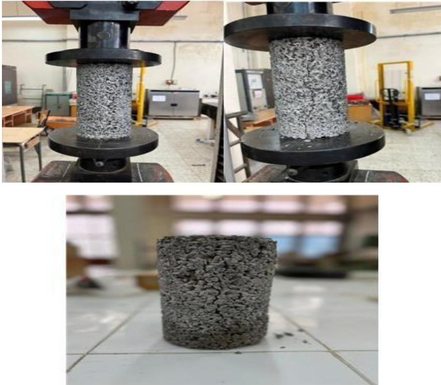
Figure III. 17 : Illustrations sur l'essai de compression.
