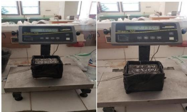
Figure III. 19 : Illustration d'essai de porosité ouverte.
