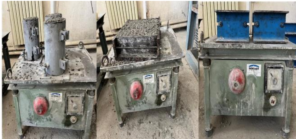
Figure III. 14 : Mise en moules.
