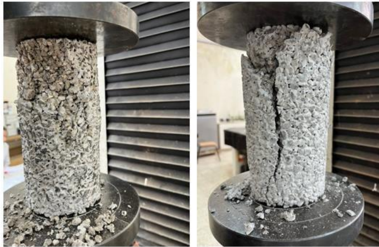
Figure IV- 1 : Essai d'écrasement en compression.
