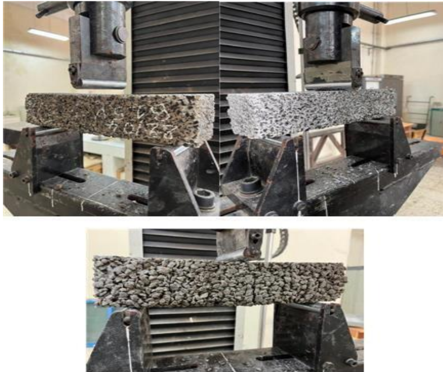
Figure III. 18 : Illustrations sur l'essai de flexion.
