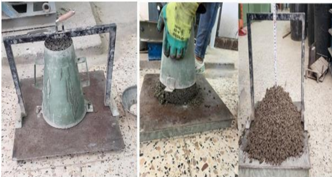
Figure III. 16 : Les étapes de l'essai au cône d'Abrams.
