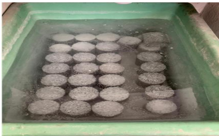
Figure III. 15 : Conservation des éprouvettes dans l'eau.
