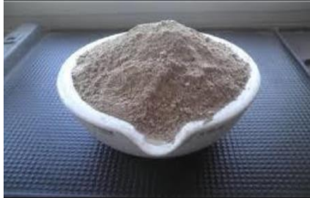
Figure II. 6: Vase de barrage tamisé avant calcination [27]
