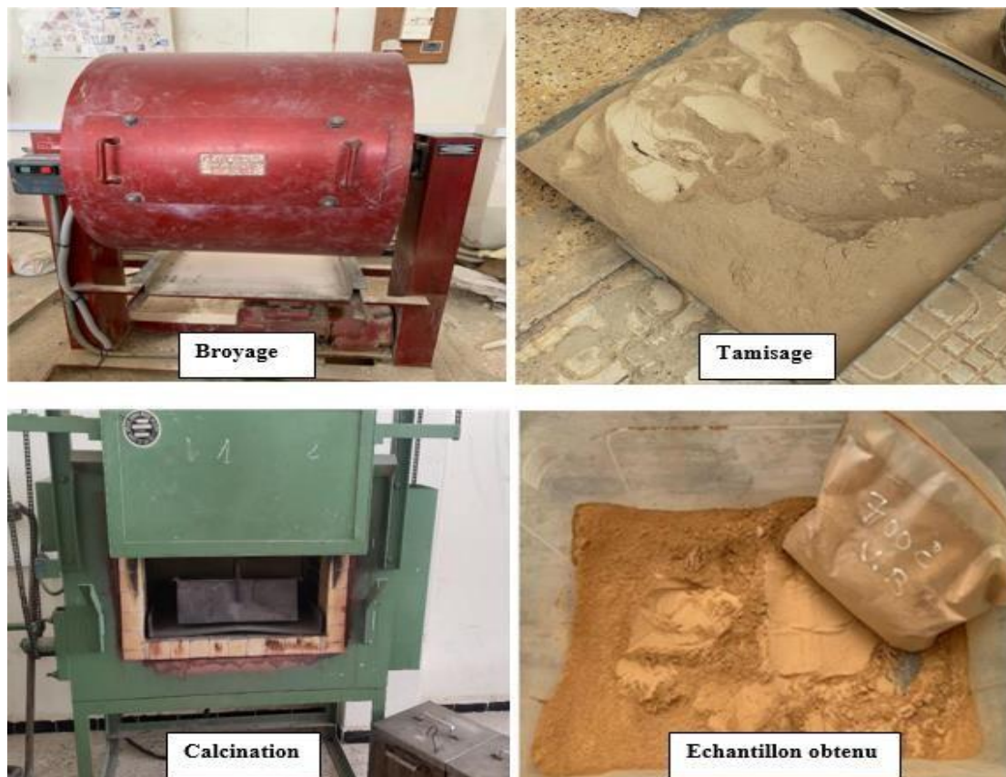
Figure III. 7: Les différentes étapes du traitement de la vase.
