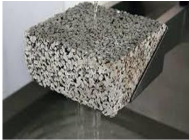
Figure I. 1 : Éprouvette en béton drainant.
