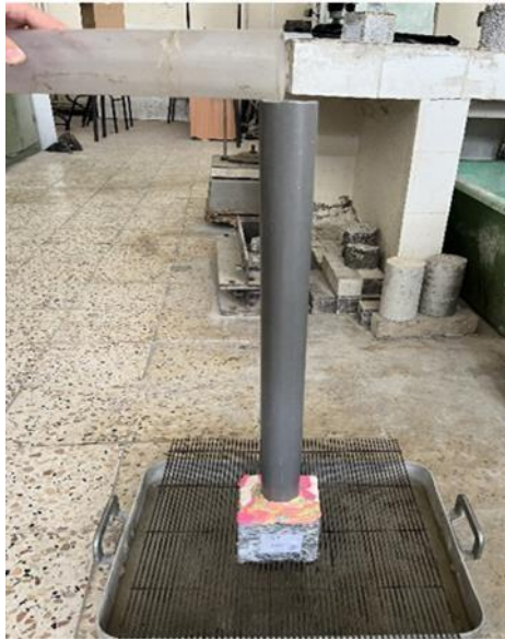
Figure III. 20: Illustration d'essai de perméabilité à l'eau.
