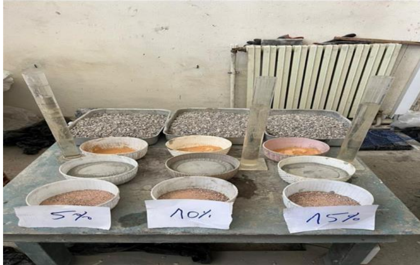
Figure III. 11: Préparation des pesées pour la confection des bétons étudiés.
