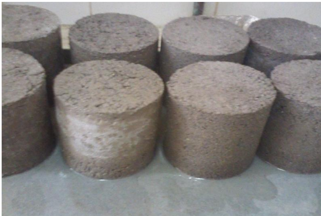
Figure IV.2: Eprouvettes de sables + (ciment-chaux) immergées dans l'eau.
