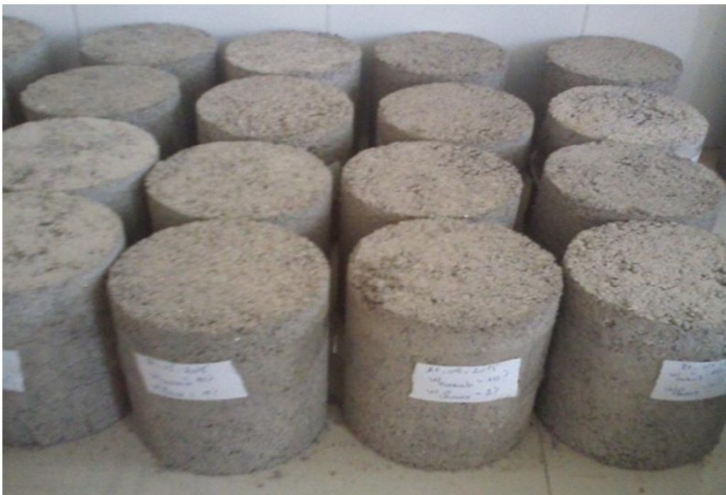
Figure IV.1: Eprouvettes de sable + (ciment-chaux) à l'état sec.
