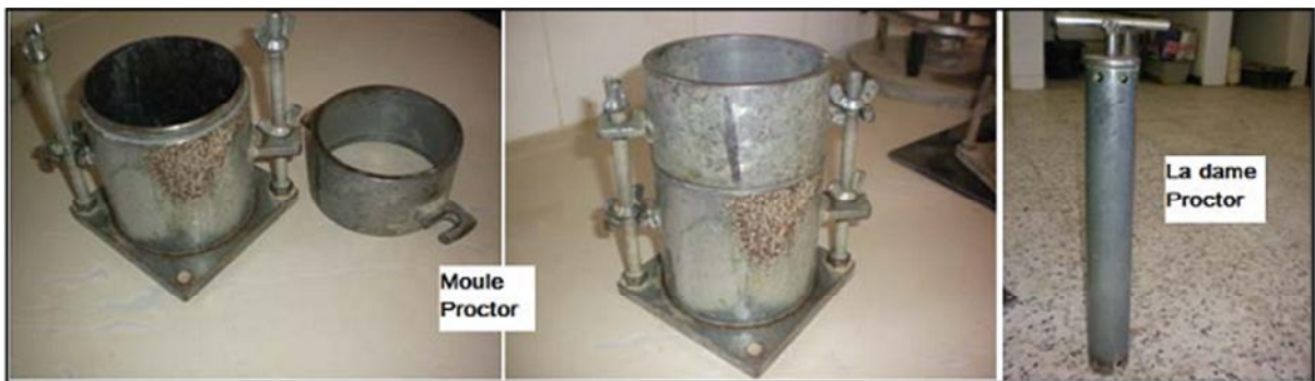
Figure III.12: Equipement de l'essai Proctor normal.
