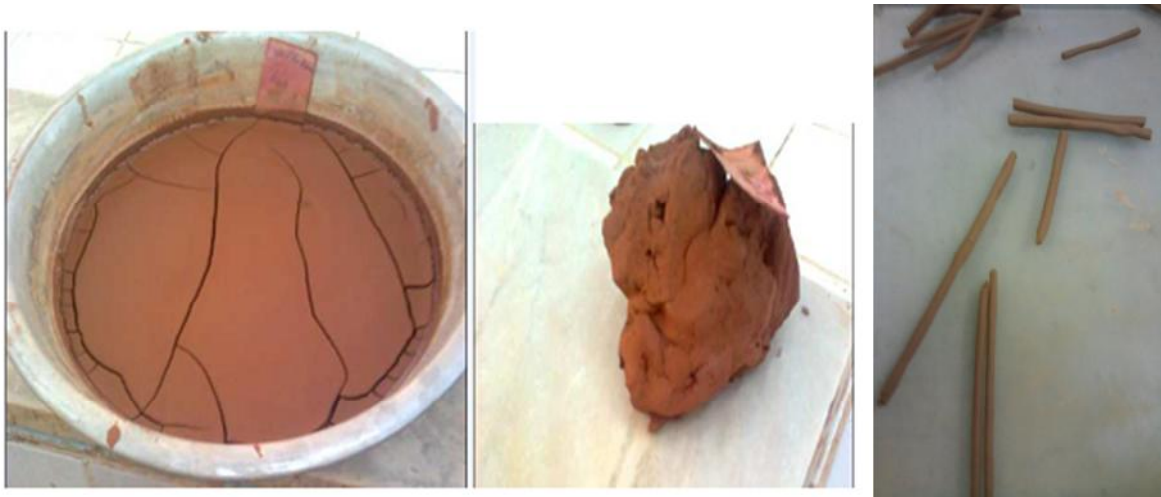
Figure III.9: Détermination de la limite de plasticité.
