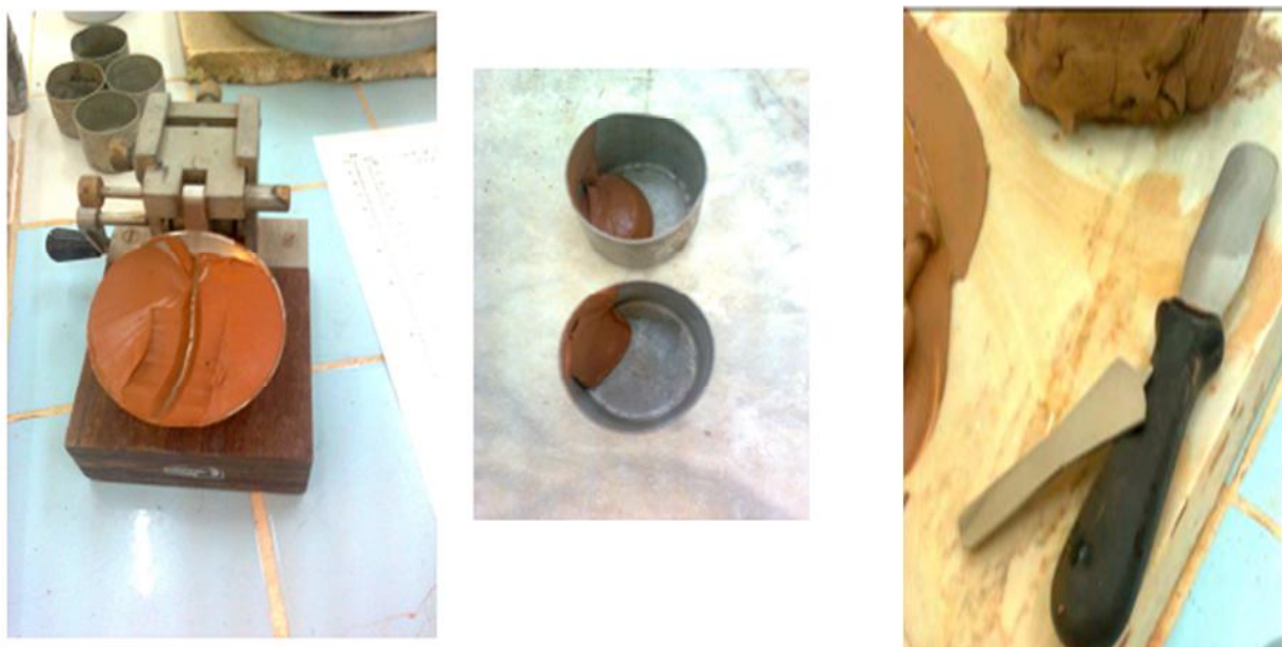
Figure III.8: Détermination de la limite de liquidité par l'appareil de Casagrande.
