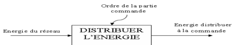
Fig. 6 : Schéma de fonctionnement d'un pré-actionneur [2].
