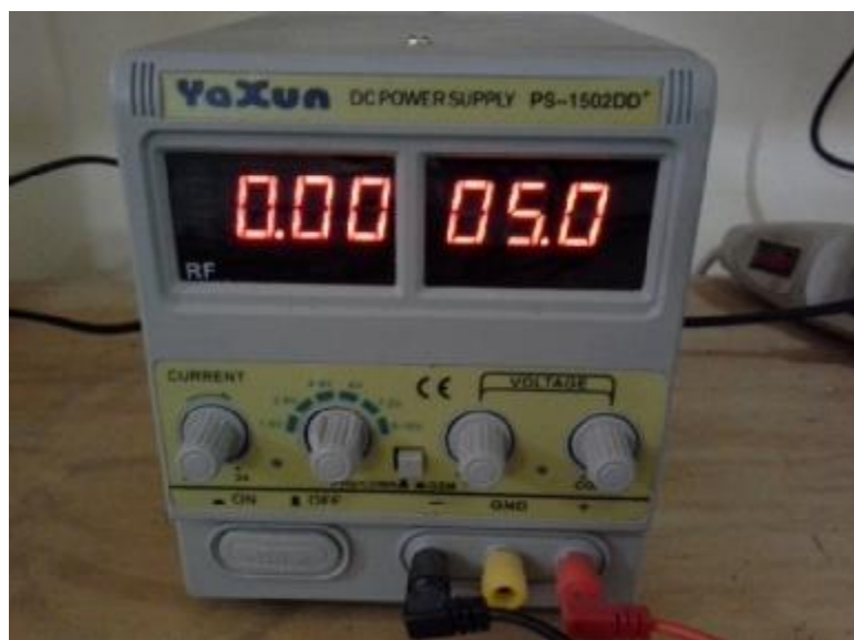
Figure IV.6. Alimentation stabilisée et régulée
