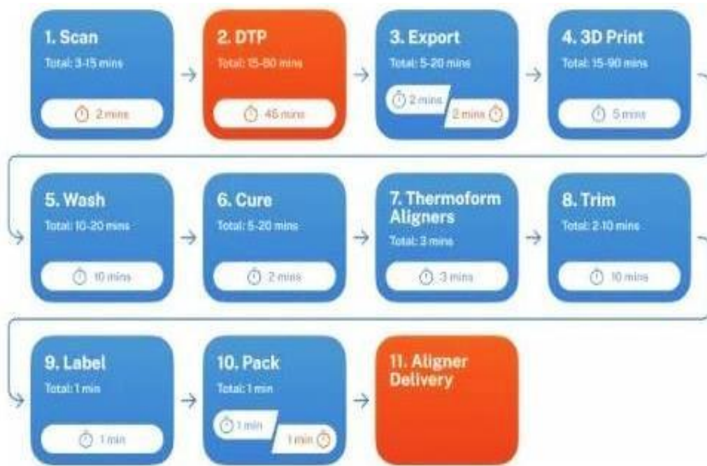
Figure 84: flux de travail pour la fabrication in house aligneurs. (89)
