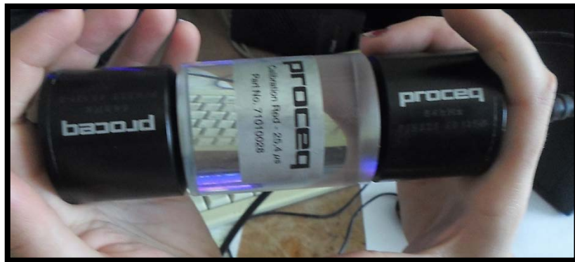
Figure II.13. Remise à zéro du Pundit Lab avec la barre de calibration
