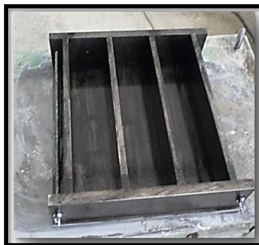
Figure II.5. Moule de confection des éprouvettes 7×7×28 cm
