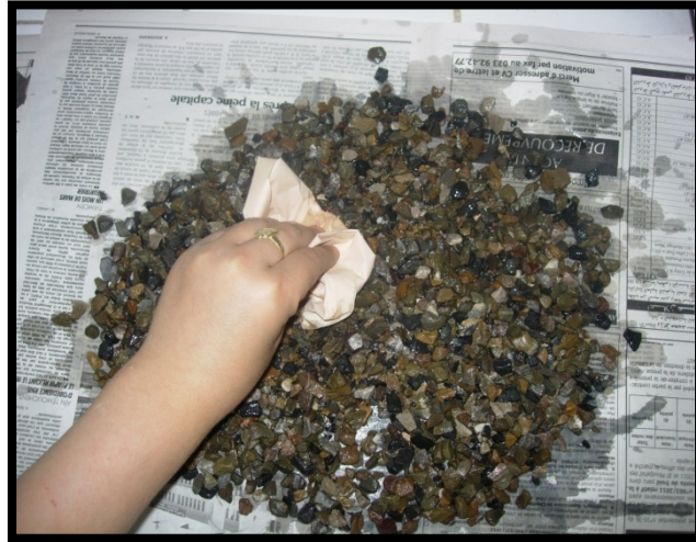
Figure 1.8 étapes de déterminations de l'absorption des granulats cas de graviers
