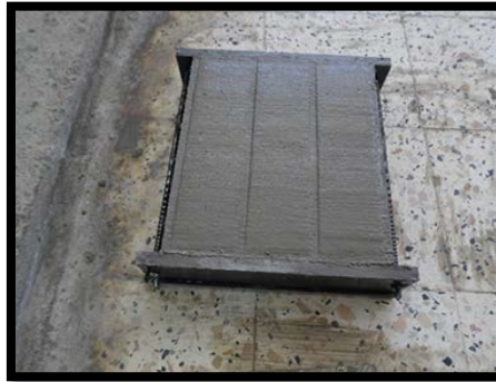
Figure II.7. Mortier après arasement
