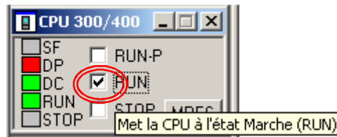
Figure -V-5 : Mise en marche de la CPU
