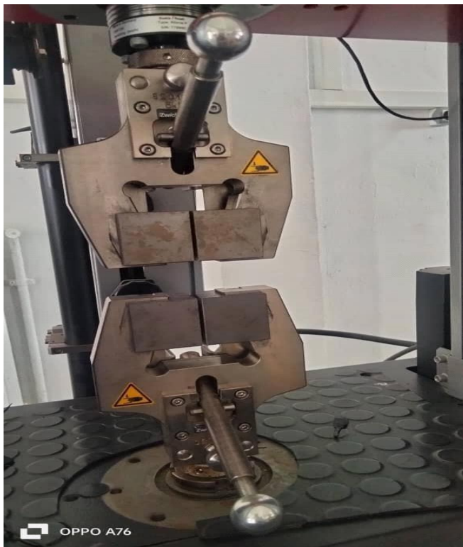
Figure III-9: Montage sur la machine de traction.
