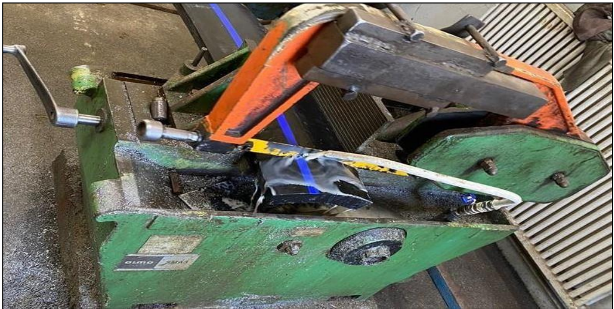
Figure III-3: Découpage une plaque en (PEHD) à l'aide d'une scie mécanique.
