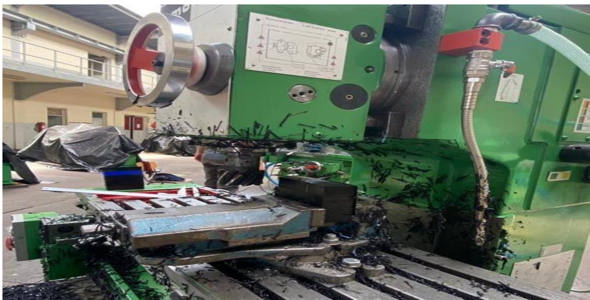
Figure III-4: Usinage d'une pièce en (PEHD) à l'aide d'une fraiseuse.
