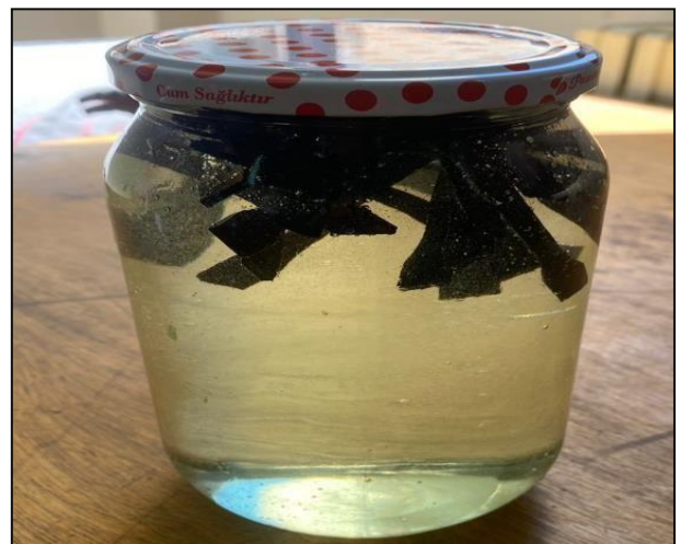
Figure III-7: Échantillons en PEHD immergés dans le chlore.
