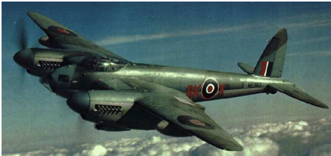
Figure 1.7 : Avion militaire Britannique en structure multicouche [9].
