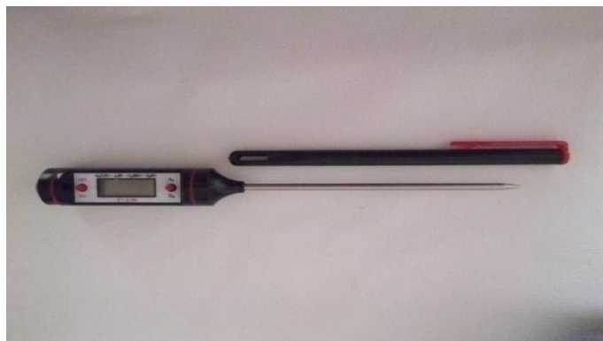
Thermomètre digital WT-1 (-50°C, 300°C)
