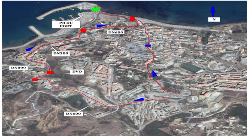
Figure II. 9 : tracé en plan du collecteur centre en DN 600.
