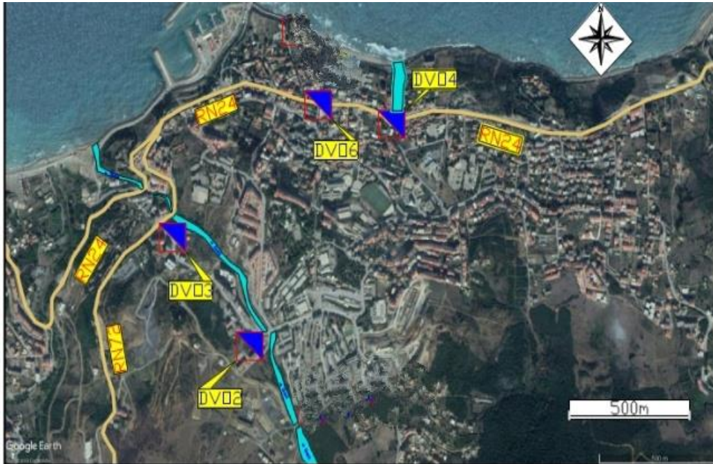
Figure V. 3 : Positions des Déversoirs d'orage projetés.
