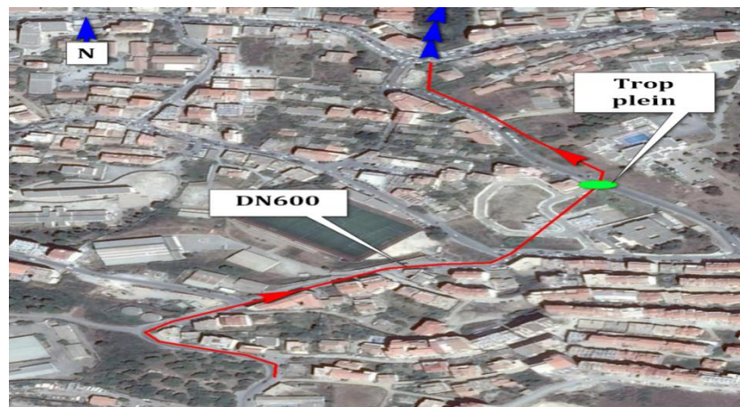
Figure II. 7 : tracé en plan du collecteur Est en DN600.
