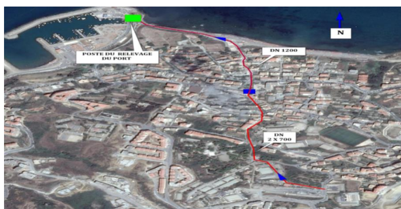
Figure II. 8 : tracé en plan du collecteur centre en DN 2 x 700 – DN 1200.
