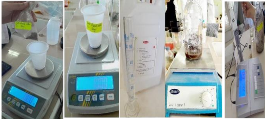
Figure 7: Les étapes de mesure du pH du sol (Guessoum, 2023)
