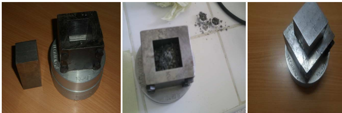
Figure III.A.8 : Moule utilisé pour la fabrication des composites de 40x40x6 mm 3 .
