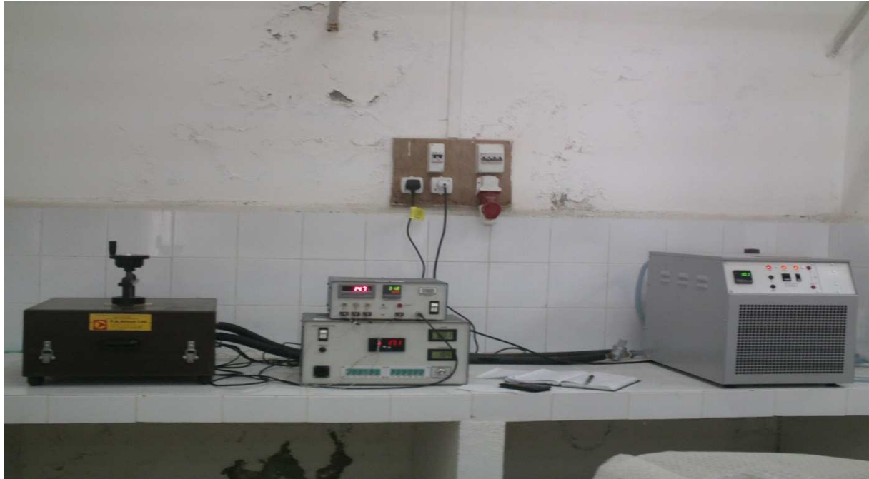
Figure III.A.19: Image de l'unité de conductivité thermique (CT mètre).
