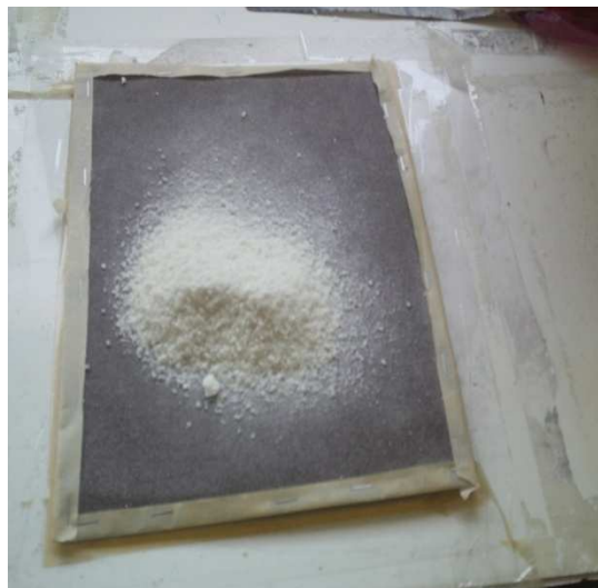
Figure.III.A.4: Grattage de la mousse polyuréthane.
