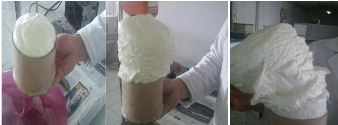
Figure III.A.3 : Obtention de la mousse polyuréthane.
