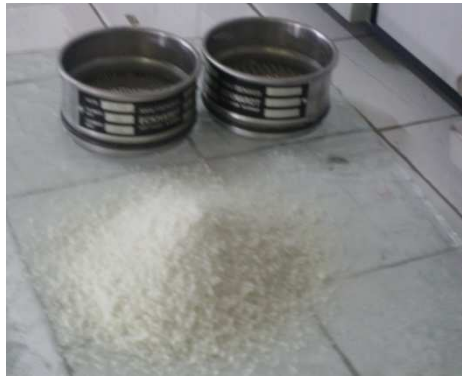
Figure III.A.5 : Tamisage de la mousse polyuréthane.
