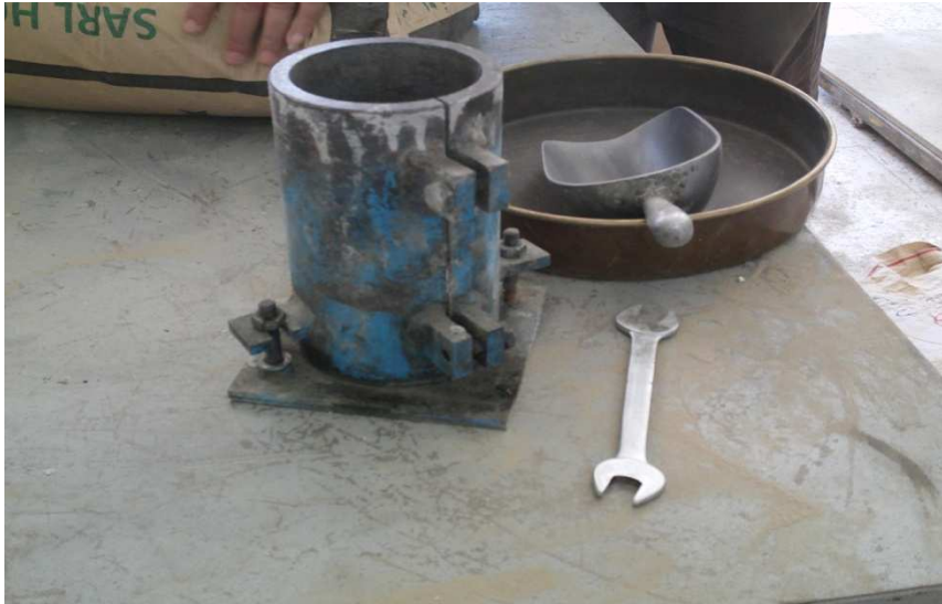
Figure III.B.3 : Moule pour la réalisation des éprouvettes cylindriques (10x20 cm 2 ).
