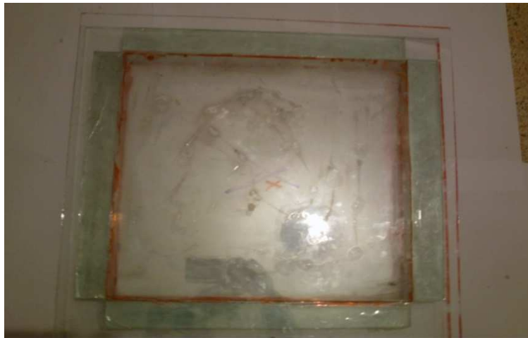
Figure .III.A.17: Image représentant le mélange versé dans le moule.
