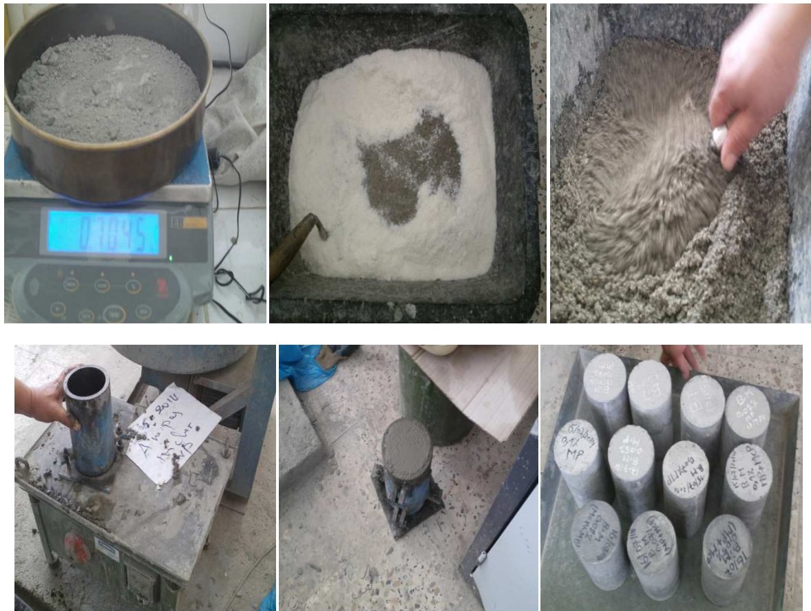
Figure III.B.4 : Images représentent les préparations des éprouvettes de béton renforcées
