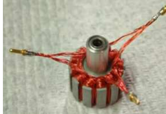
Figure VI.3: stator avec enroulement en triangle.
