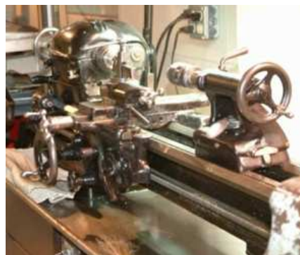
Figure VI.4: image d'un tour universel pour l'usinage des pieces rondes.
