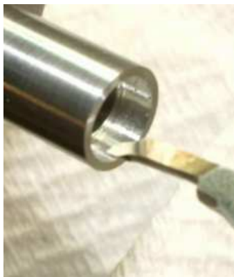
Figure VI.7: Alésage de l'emplacement de roulements
