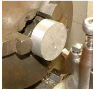
Figure VI.5: pièce en aluminium brute qui deviendra le rotor, fixé sur le mandrin d'un tour.
