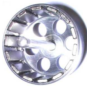
Figure VI.1: le rotor avec les aimants fixés a sa surface intérieure.
