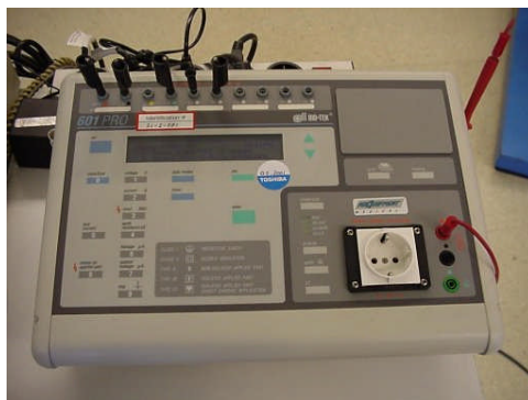
Fig. 91 : Testeur de sécurité électrique (testeur 601 Pro)
