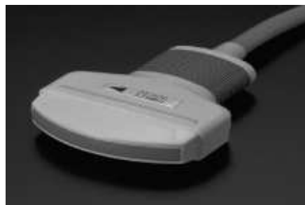
Fig.11. Image d'une sonde à balayage sectoriel
