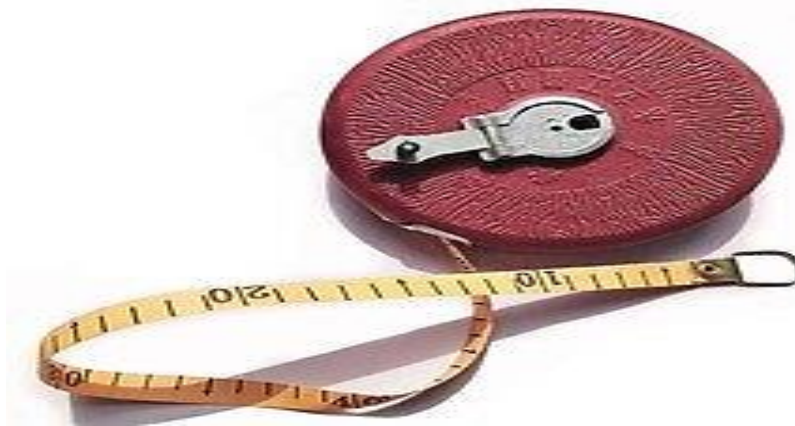
Figure 37 : Double Décamètre utilisé pour mesurer le rayon \text{®} (5,64m) de la placette.
