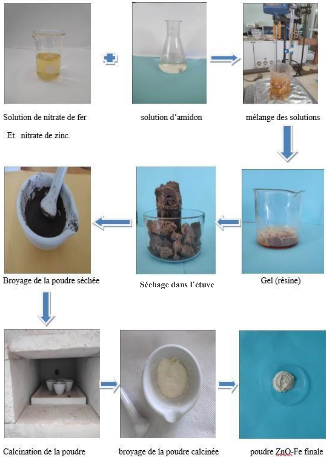
Figure II.2 : Illustration de la synthèse de ZnO-Fe par la voie sol-gel.
