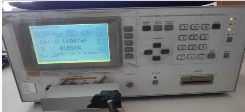
Figure. II.7 : Image de l'impédancemétrie HP 4284A
