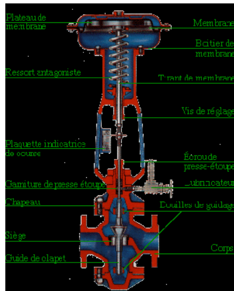
Figure II.6.a Image réelle d'une vanne proportionnelle. Figure II.6.b Eléments constituant la vanne[6]
