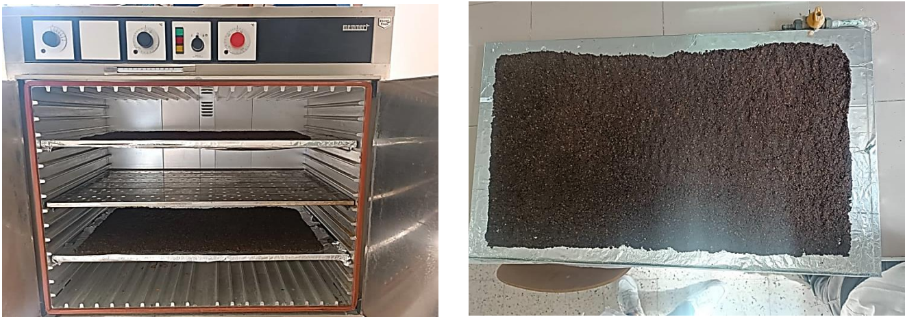
Figure 11 : séchage de grignon d'olive dans l'étuve
