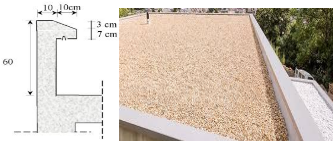
Figure III.5 1: schéma descriptifs de l'acrotère.
