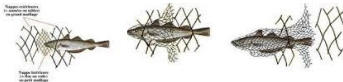
Figure 40: enchevêtrement du poisson dans un filet trimail
