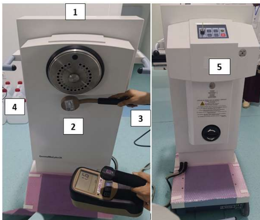
FIGURE 3.17 – Points de mesure des débits de dose autour du projecteur : 1 — dessus, 2 — avant, 3 — droite, 4 — gauche, 5 — arrière.
