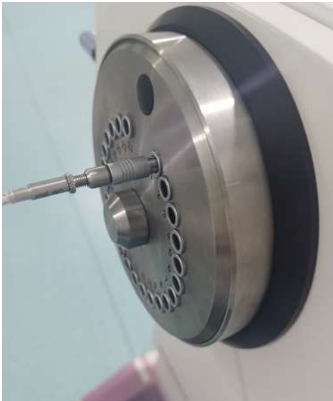
FIGURE 3.20 – Débranchement du tube de transfert dans un canal
