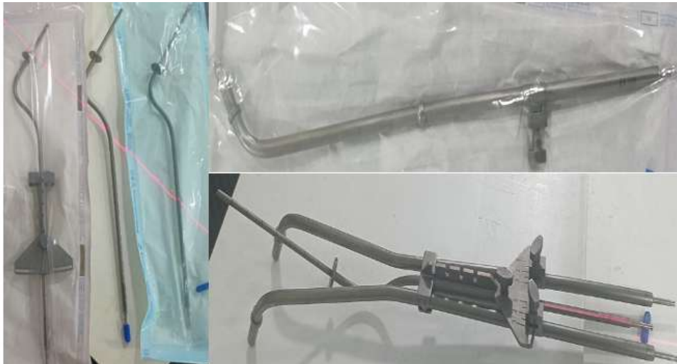
FIGURE 2.15 – Applicateurs Fletcher de 4cm, 6cm et 8cm de longueur
