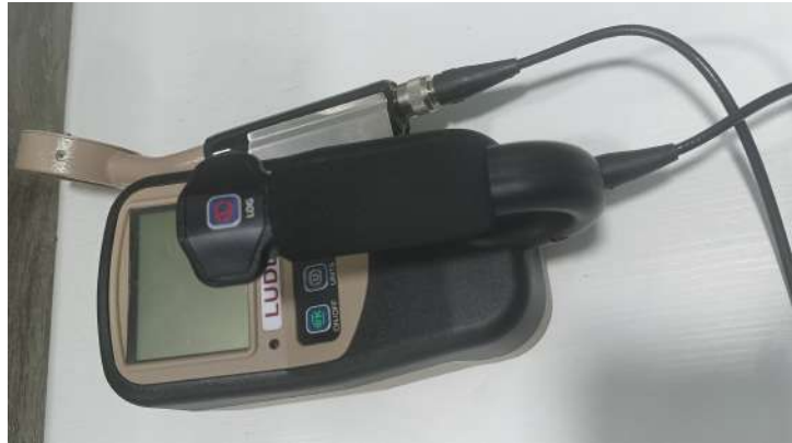
FIGURE 2.3 – Détecteur de mesure de rayonnement
