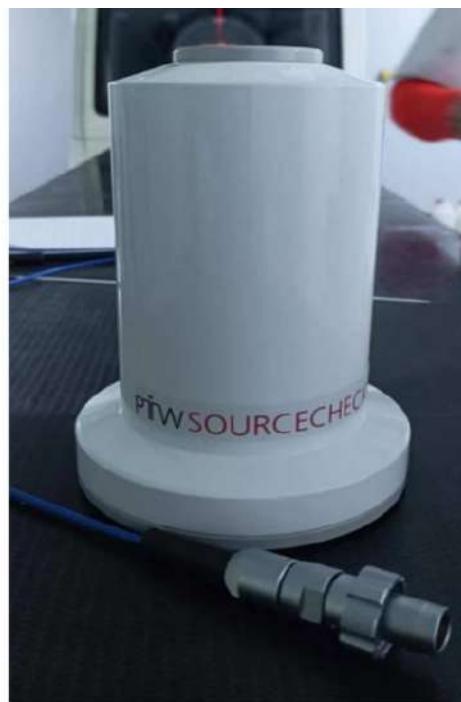
FIGURE 2.2 – Chambre à puits modèle TM33005 de PTW
