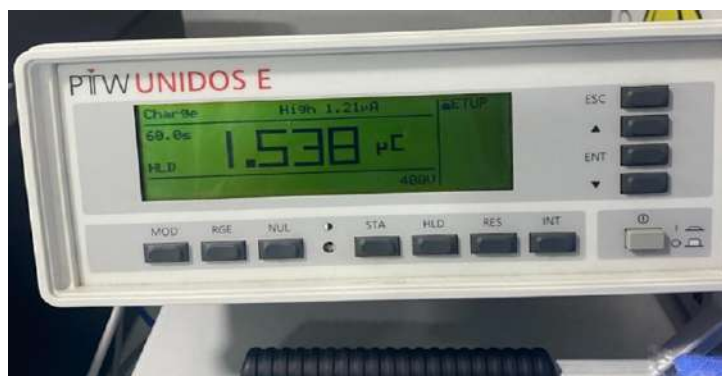
FIGURE 2.4 – Electromètre UNIDOSWebline de PTW
