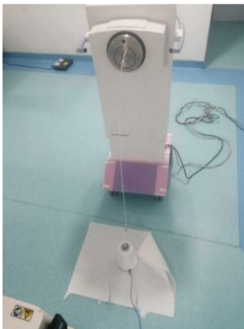
FIGURE 3.34 – Dispositif de contrôle d'étalonnage de la source HDR (chambre + projecteur)
