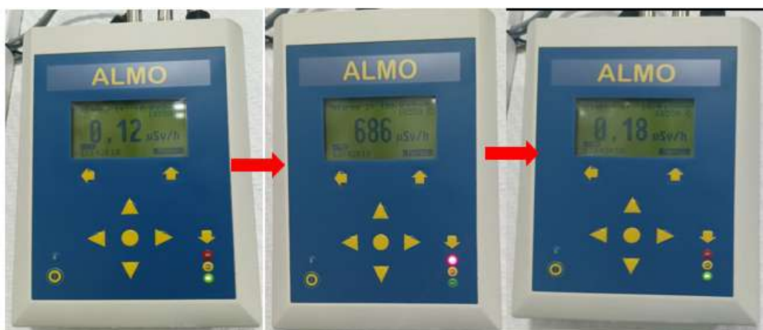
FIGURE 3.18 – indication de la sortie et la rentre de la source
