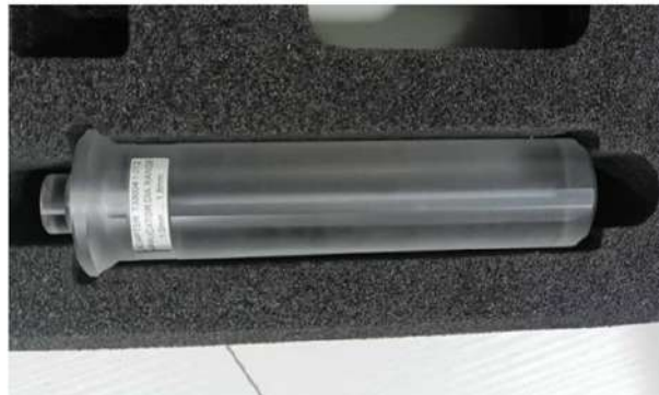
FIGURE 2.5 – Porte-source adaptateur modèle T33004.1.012 de PTW
