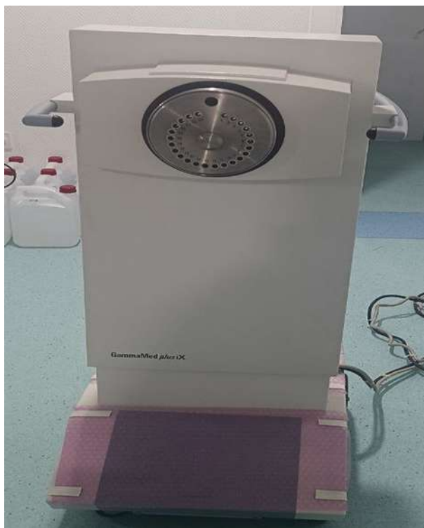
FIGURE 2.1 – Projecteur de source GammaMed Plus iX de Varian
