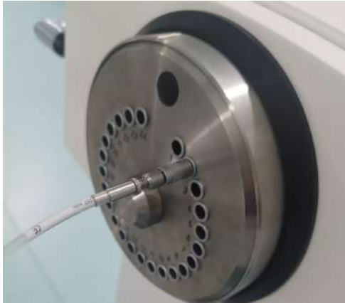
FIGURE 3.19 – Erreurs de branchement dans les canaux
