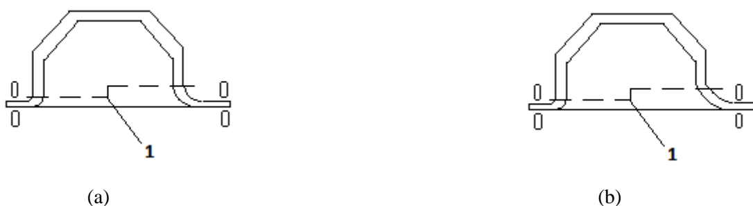
Figure IV.5. Contour dans la zone de déchet pour une coupe en 3D ; a) défavorable ; b) favorable
