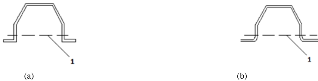
Figure IV.6. Contours dans la zone de déchet pour une coupe dans un plan ; a) défavorable ; b) favorable
