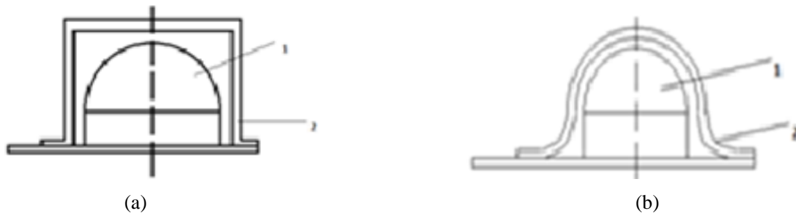
Figure IV.4. Contour de blister ; a) défavorable ; b) favorable
