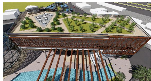
Figure 102:toiture végétalisée source: auteurs
