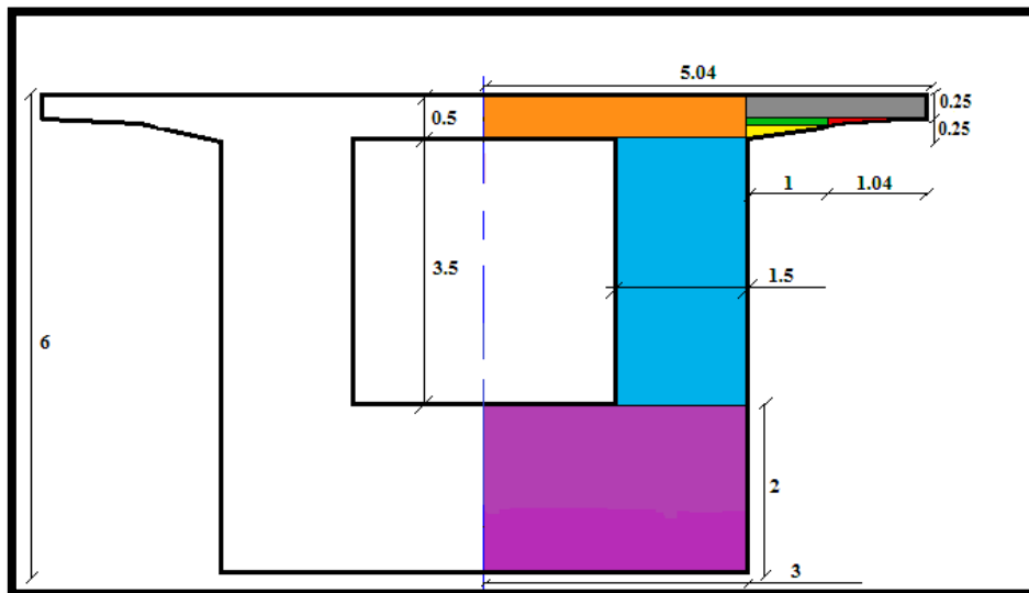
Figure II.25 : Coupe transversale du voussoir sur pile plein.
