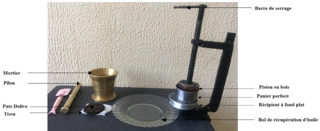
Figure 10 : Processus d'extraction d'huile d'olive appliqué au laboratoire.
