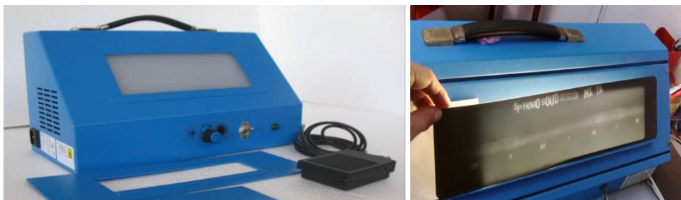
Figure 2.9: Négatoscope pour interprétation des films.
