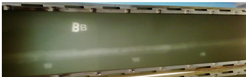
Figure 4.11: Cliché sain de côté BB, paramètre 90-110.
