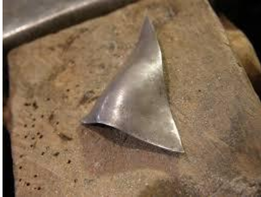
Figure 1.4 : feuille en plomb facile à façonner.
