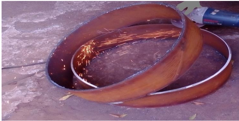
Figure 3.3: Finition des chanfreins et des talons par meulage manuel.
