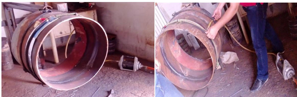
Figure 3.11: Inspection par gammagraphie de l'éprouvette de ligne.
