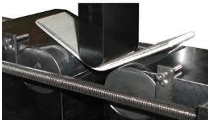
Figure 1.2 : Déformation facile d'un alliage métallique.
