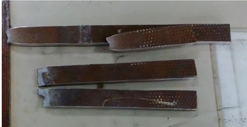
Figure 4.13: Résultat test de traction de l'éprouvette de réparation.
