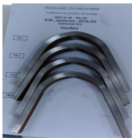
Figure 4.9: Résultat de test pliage de coté.
