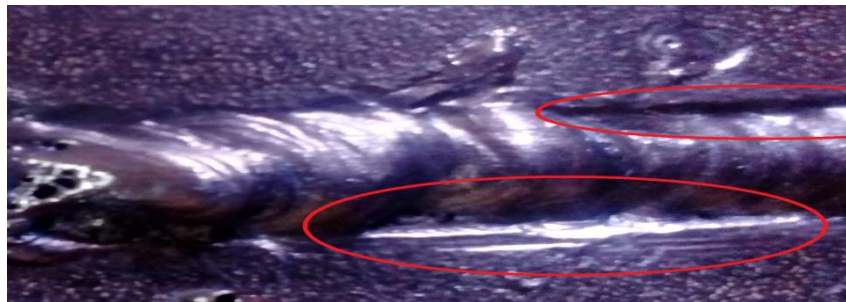
Figure 2.9 : Défauts de caniveaux.
