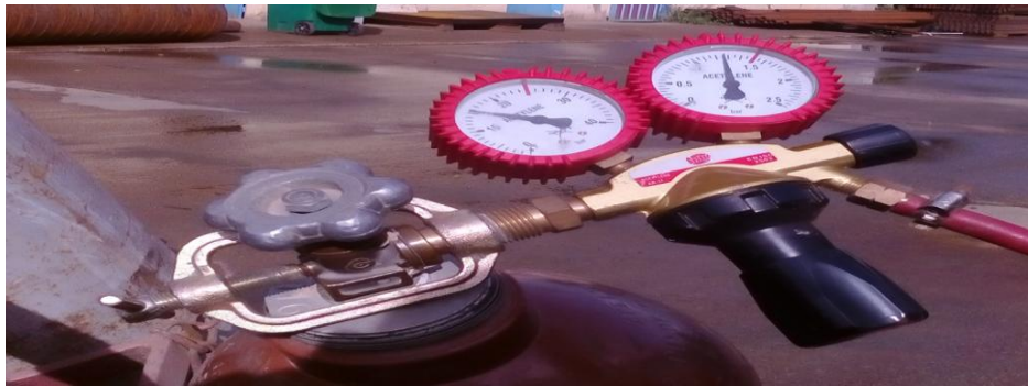
Figure 8.2 : Manomètres-détendeurs/régulateurs de débit.
