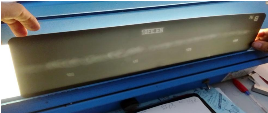
Figure 4.4: Cliché de côté BN, paramètre 100-130.
