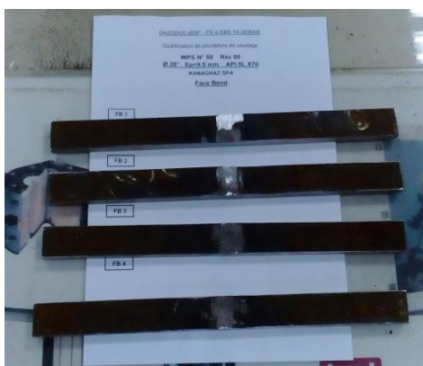
Figure 3.15: Barreaux pour test de pliage.
