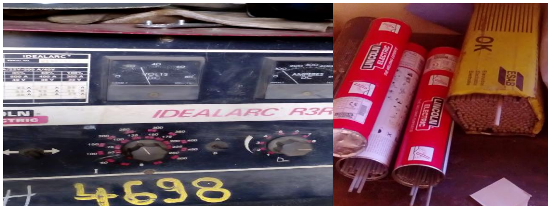
Figure 3.5: Poste de soudage à l'arc avec les électrodes enrobées cellulosiques utilisé dans qualification de procédé.
