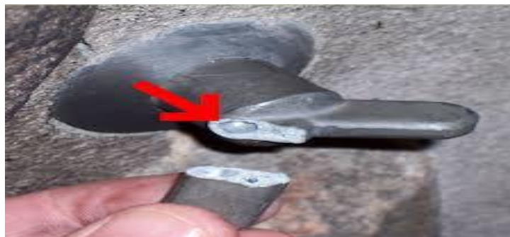
Figure 1.1: Matériau fragile (fonte) avec un défaut de soufflure.
