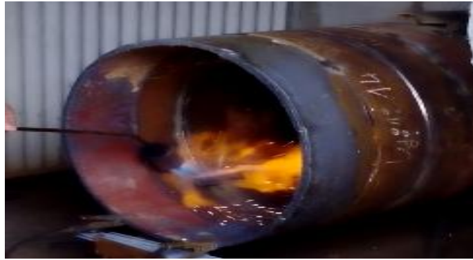
Figure 3.6 : Préchauffage de l'éprouvette jusqu'à 130 °C.
