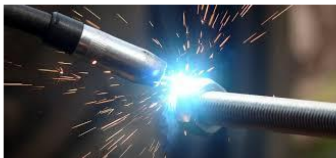
Figure 1.11 : Bombardement par électrons ; création de l'arc électrique.
