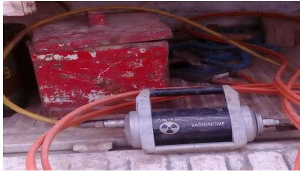
Figure 1.3: Container de transport et celui de travail pour source IR-192.
