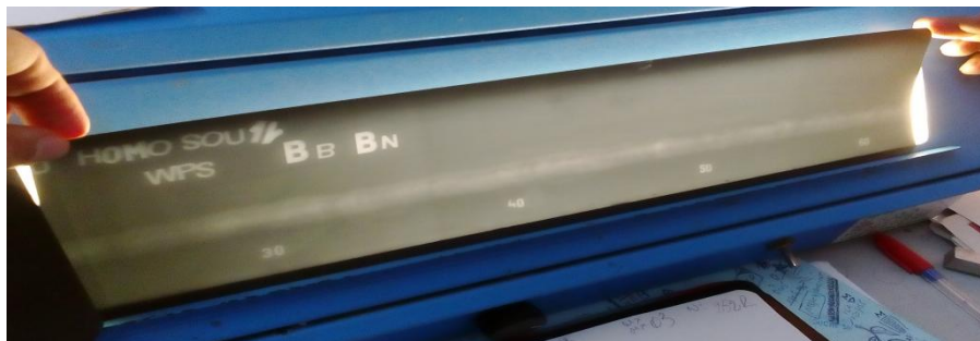
Figure 4.2: Cliché de côté BB, paramètre 30-60.
