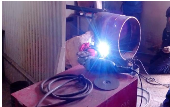
Figure 3.7: Soudage de l'éprouvette de ligne.
