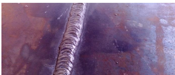
Figure 3.9: Bonne qualité visuel de cordon de soudure.
