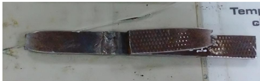
Figure 4.7: Résultat test de traction pour l'éprouvette de ligne (rupture hors soudure).
