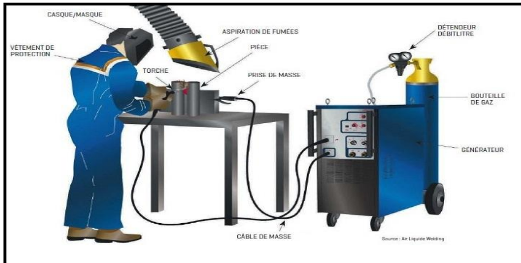
Figure 3.4 : Principe de soudage MIG/MAG.
