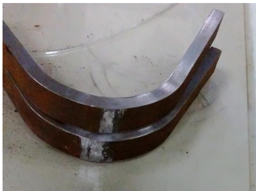
Figure 4.15: Résultat de test de pliage de coté de l'éprouvette de réparation.
