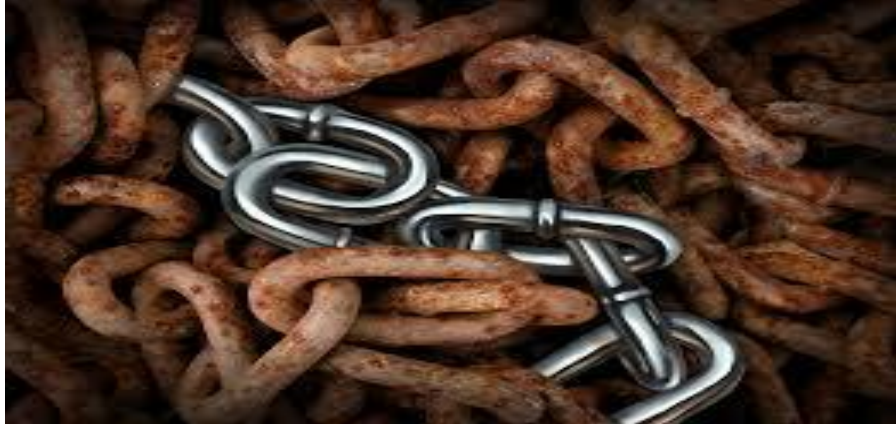
Figure 1.8 : Chaîne en métal ferreux, en corrosion et un autre inoxydable
