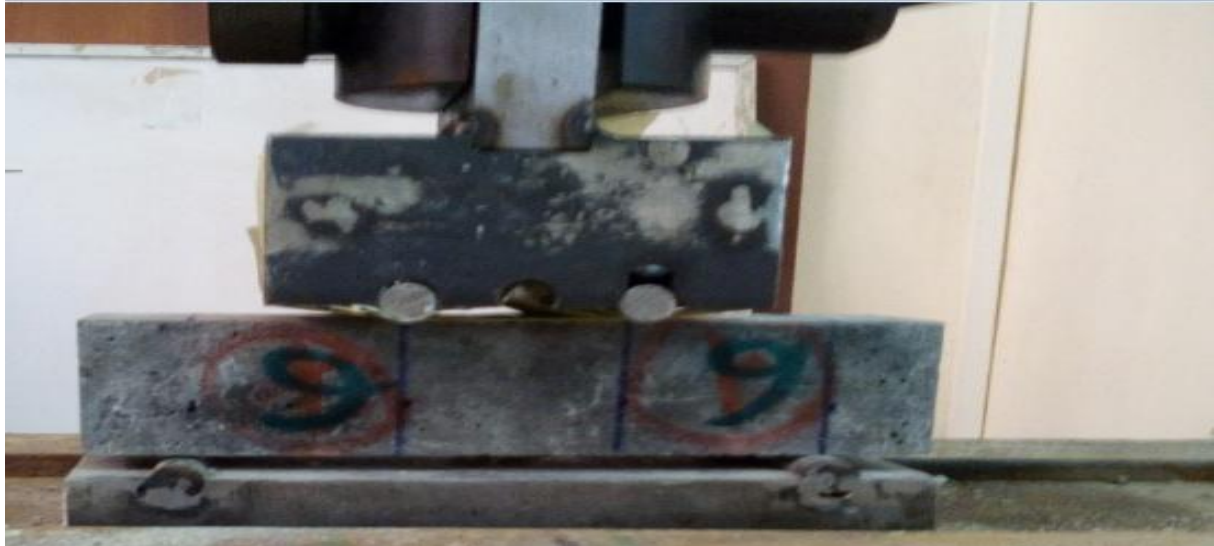
Figure IV.15. Dispositif pour l'essai de résistance à la flexion (4 points)
