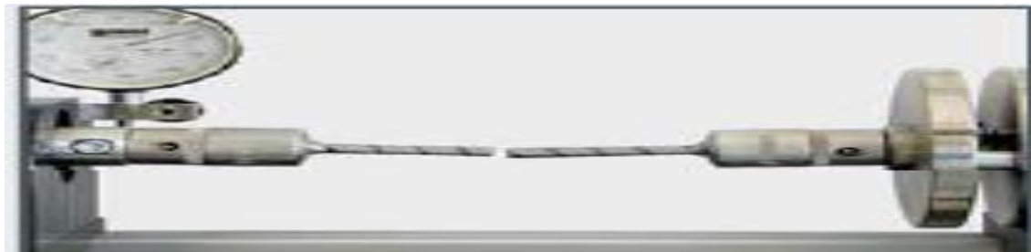
Figure IV.14. Machine de traction par torsion
