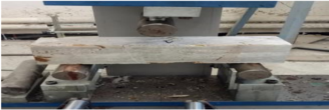
Figure IV.16. Dispositif de l'essai mécanique de rupture par flexion (3 points)
