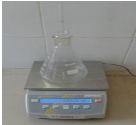
A- Pesé du pycnomètre à vide M1.
