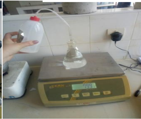
D- masse de pycnomètre avec son Bouchon plus eau M4
