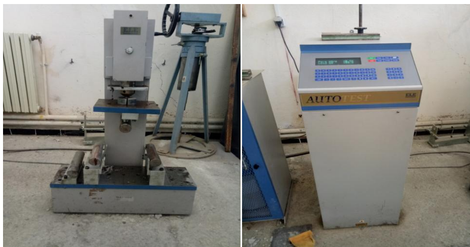
Figure IV.12. Machine de l'essai de traction par flexion (Laboratoire de Béton UMMTO)
