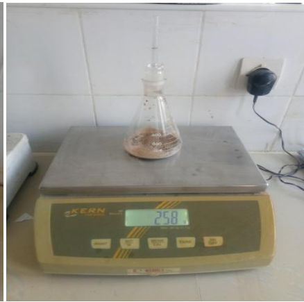
B- Pèse le pycnomètre et son bouchon Plus l'échantillon M2
