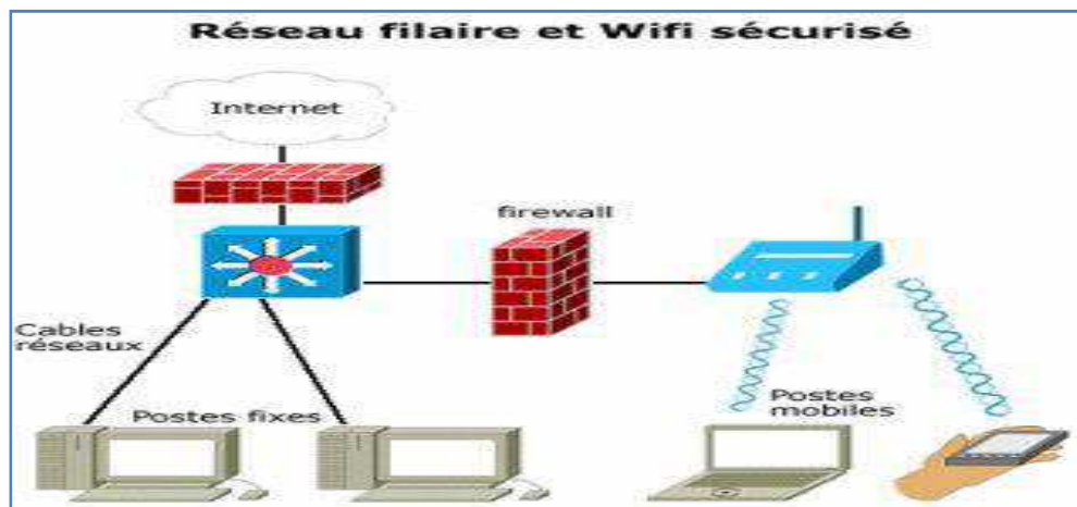
Figure.II.14 : Réseau filaire et Wifi sécurisé
