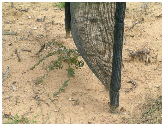
Figure 24. Ombrière constituée d'un fin grillage de plastique tendu entre deux piquets. Idée de dissocier l'effet d'ombrage de l'effet mécanique des tubes (Amandier, 2013)
