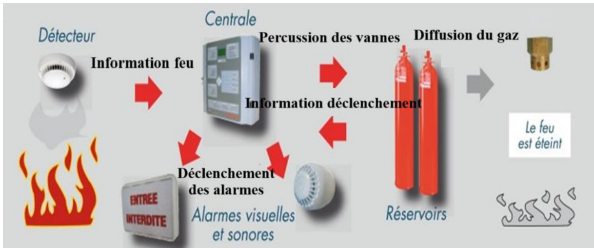
Figure.I.20. Exemple de système de détection incendie couplé à une installation d’extinction à gaz [Desautel]
