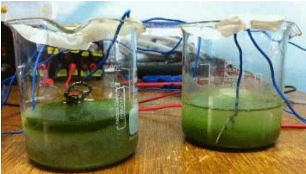
**Figure 16 :** Electrofloculation des microalgues (CABATUANDO et *al.*, 2011).
