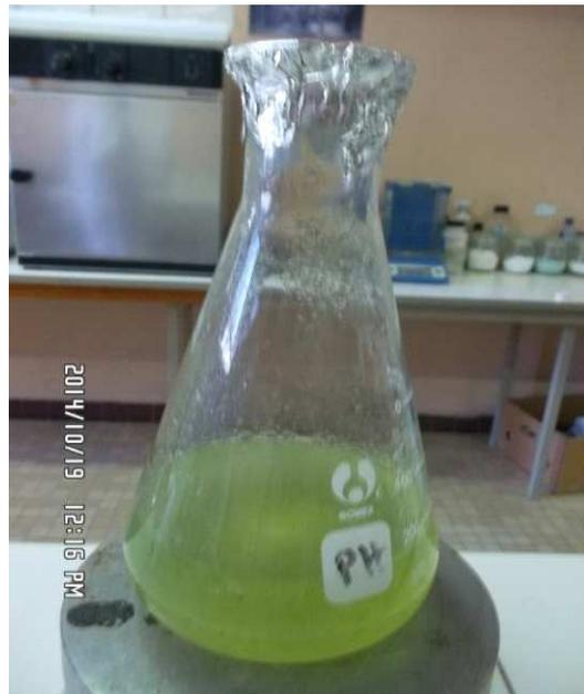
**Figure 25 :** Dispositif de production de biomasse en culture discontinue sur le milieu BB
