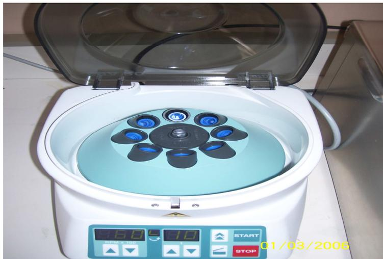
**Figure 13 :** Centrifugeuse modèle *Hettich*. (ANONYME, 2006)
