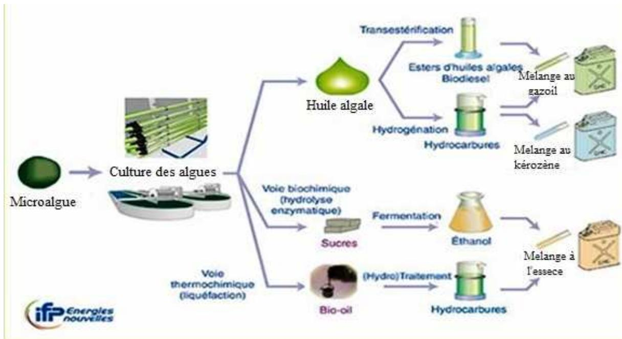
**Figure 21** : Procédés de production de biocarburant via microalgues (FILALI 2012).
