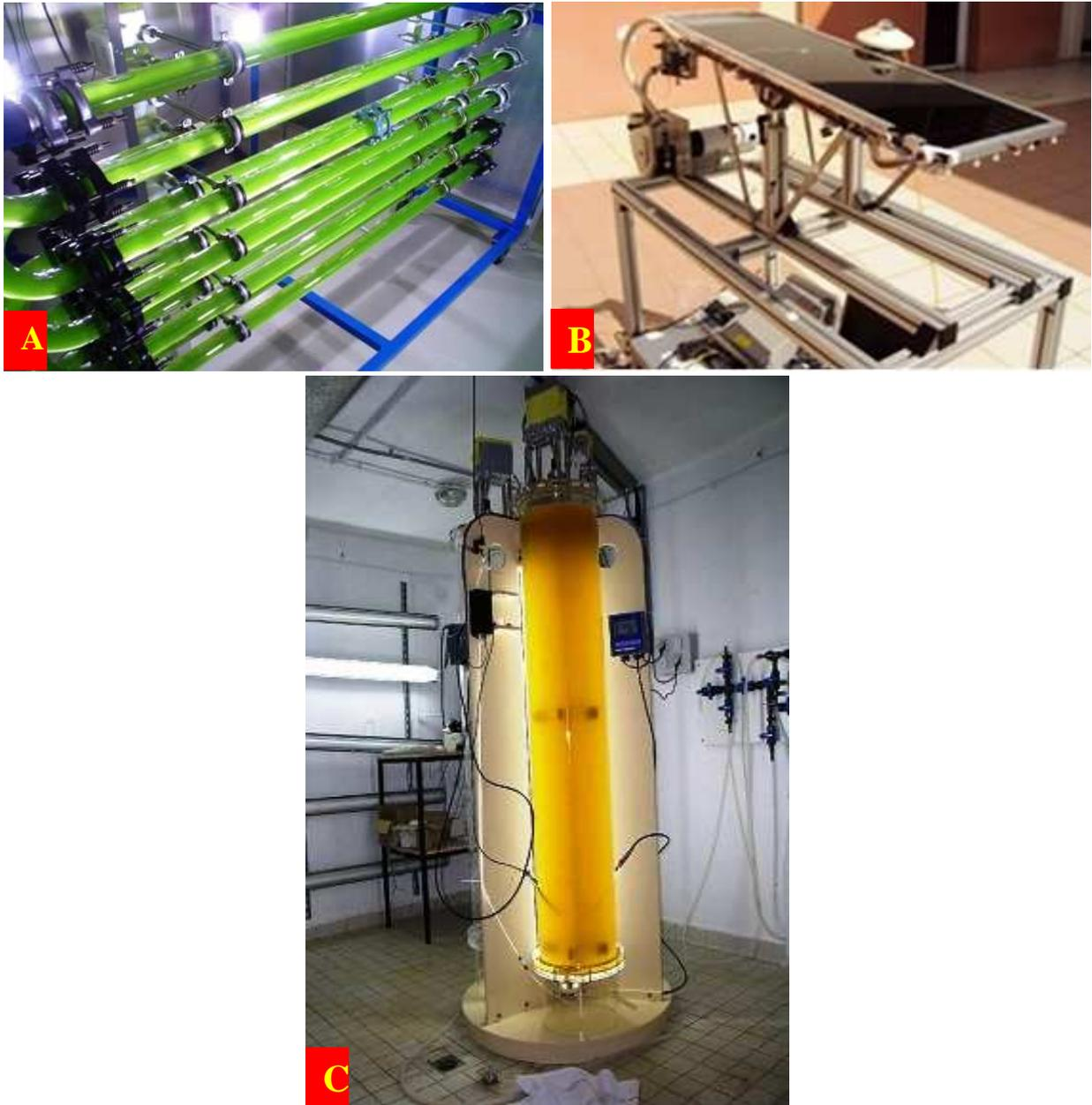
**Figure 10** : Photobioréacteur (PBR) de laboratoire pilote à éclairage externe.
