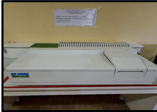
Figure 25 : Spectrophotomètre UV-VISIBLE
