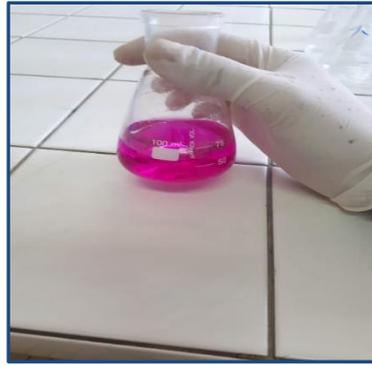
**Figure 18 :** Neutralisation du mélange avec NaOH (30%) en présence de phénolphtaléine
