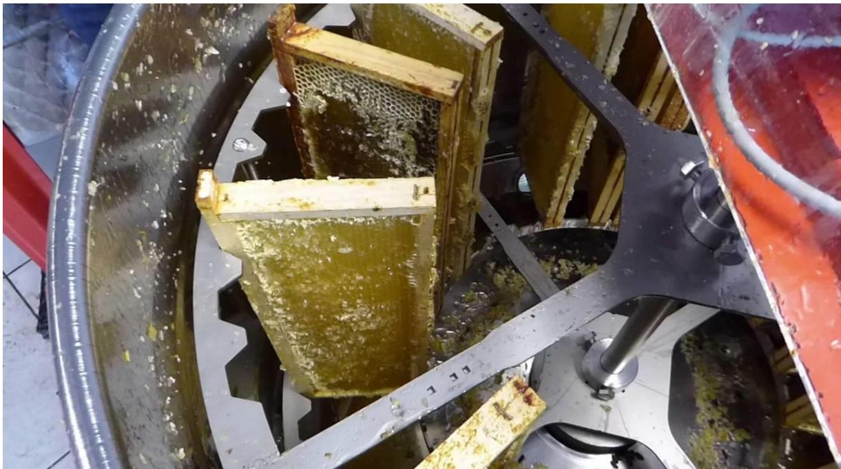
**Figure 6 :** Cadres désoperculés dans le panier de l'extracteur [25]
