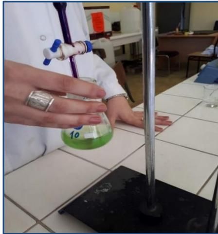
**Figure 21:** Dosage permanganométrique de la solution
