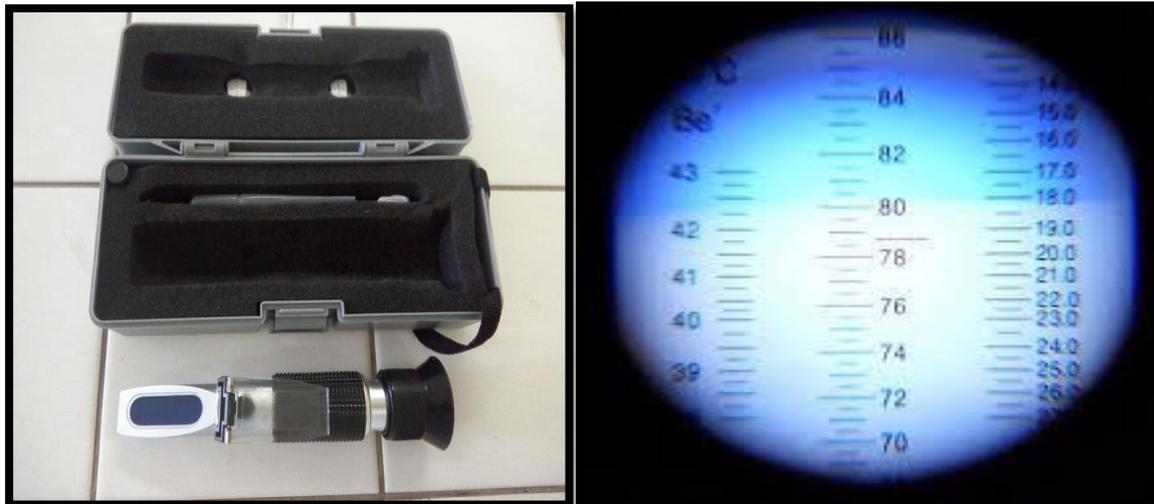
**Figure 9** : Réfractomètre à miel (Chincan)
