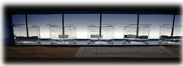
Fig. 17 schéma du Jar-test utilisé dans un laboratoire
