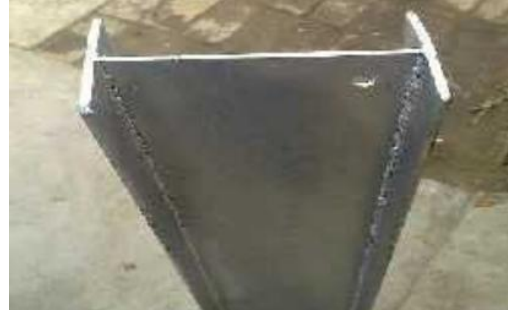
Figure : Poteau métallique HPN.
