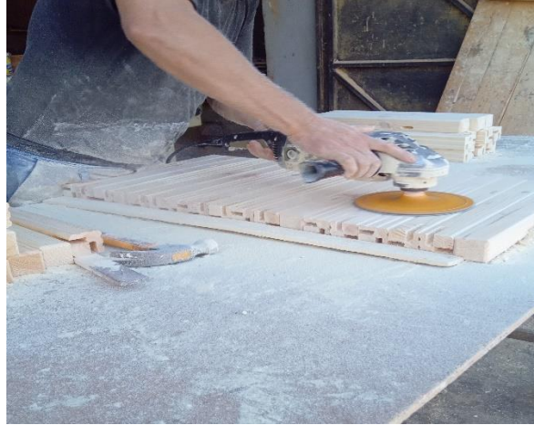
Figure III- 3: Opération de ponçage.
